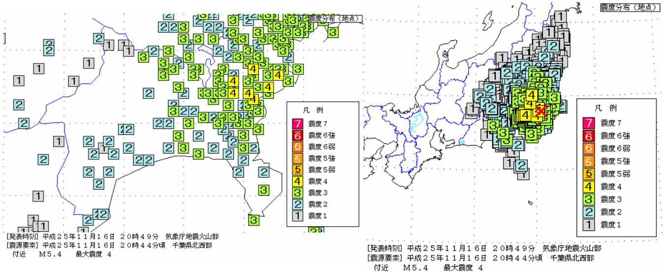
図1 観測地点毎の震度分布図(県内拡大図)
