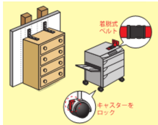
図4 家具類等の固定の例
