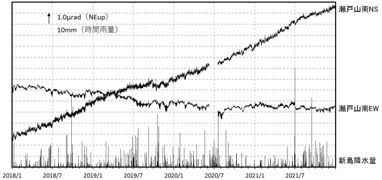
図4 新島 瀬戸山南観測点の傾斜変動（2018年1月1日～2021年12月31日） 図中の空白部分は欠測を示します。 ・火山活動によるとみられる変動は認められませんでした。
