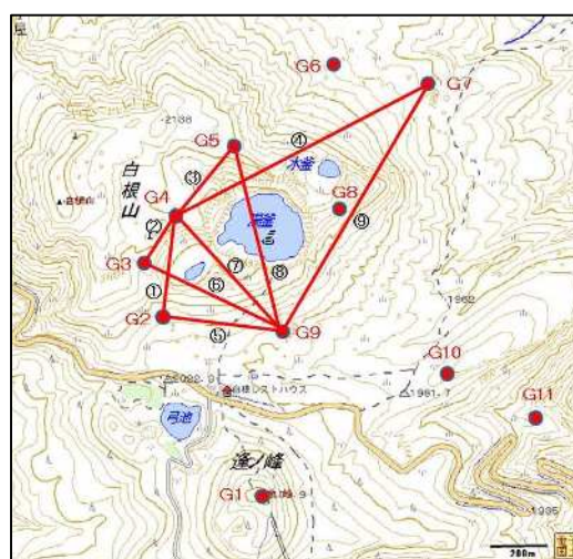
図 6 GNSS 繰り返し観測の基線配置
