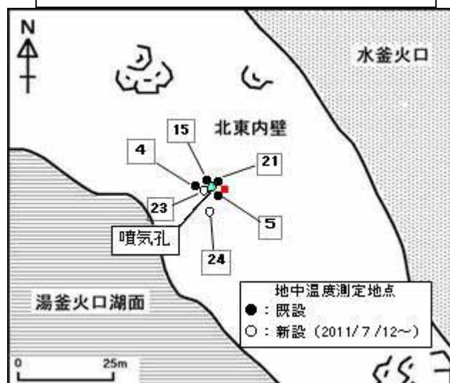
図2 草津白根山 湯釜周辺図 現地調査観測による観測位置と撮影方向 : 地表温度観測地点 (V: 撮影方向) : 地中温度観測地点 : 噴気温度観測位置
