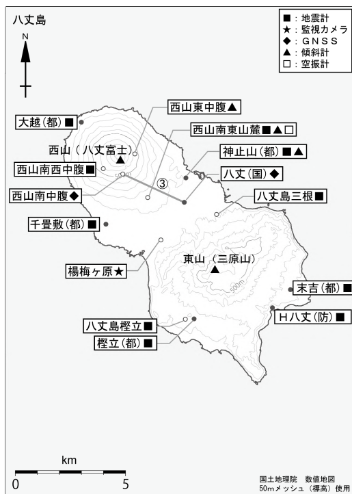
図4 八丈島 観測点配置図 GNSS基線 は図2の に対応しています。
