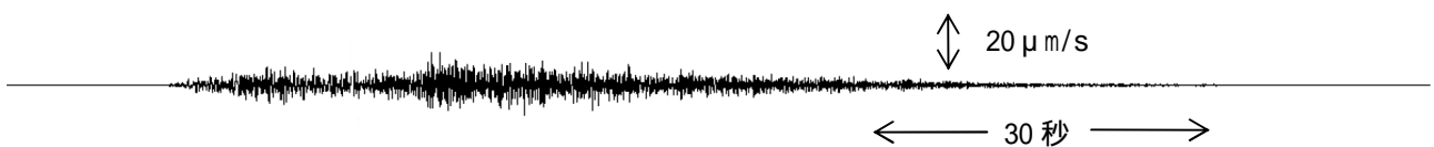
図8 三宅島 火山性微動波形(7月18日15時15分頃、雄山北東観測点上下動) ・7月18日15時15分頃、火口付近が震動源と推定される振幅の小さい火山性微動(最大振幅9.5 μm/s、継続時間約90秒)が発生しました。この火山性微動の前後で、噴煙の状況に変化はみられず、傾斜変動も観測されませんでした。
