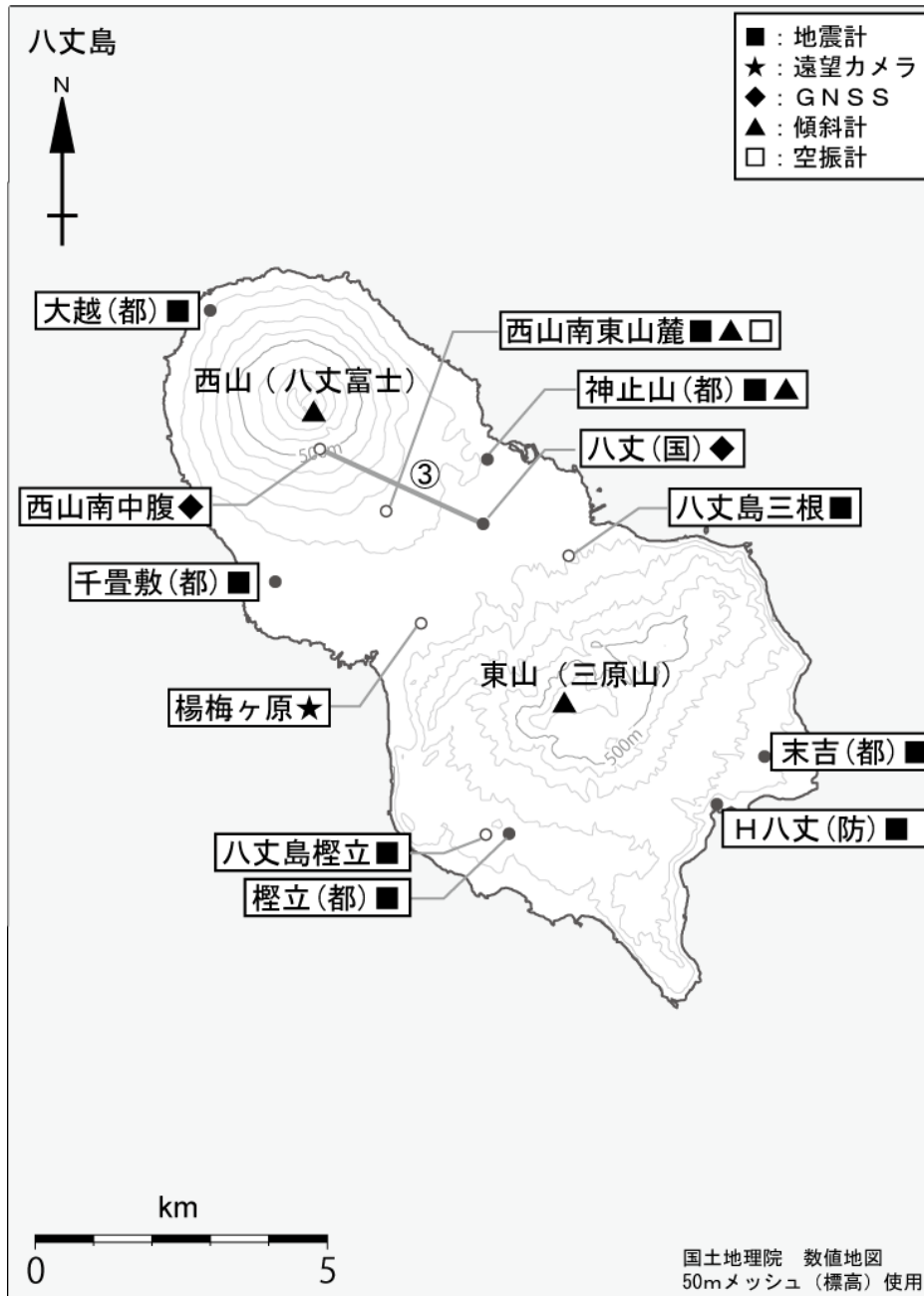
図4 八丈島 観測点配置図 GNSS 基線 は図2の に対応しています。
