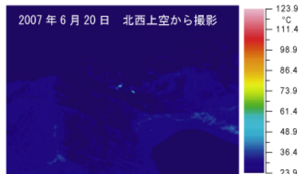
右図 赤外熱映像装置 1) で捉えた主火口及びその周辺の地表面温度分布
