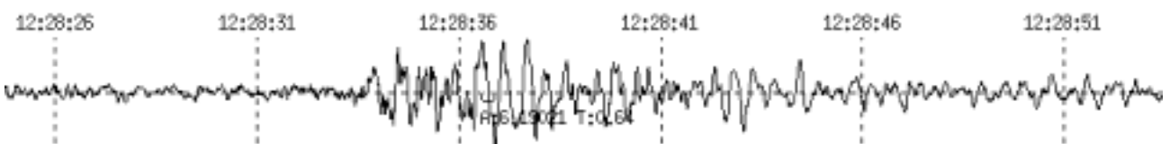
図 8 降灰を伴ったと思われる低周波地震の波形（3月28日12時28分A点NS成分） 最大振幅：約 6.2m/kine 周期：約 0.6 秒
