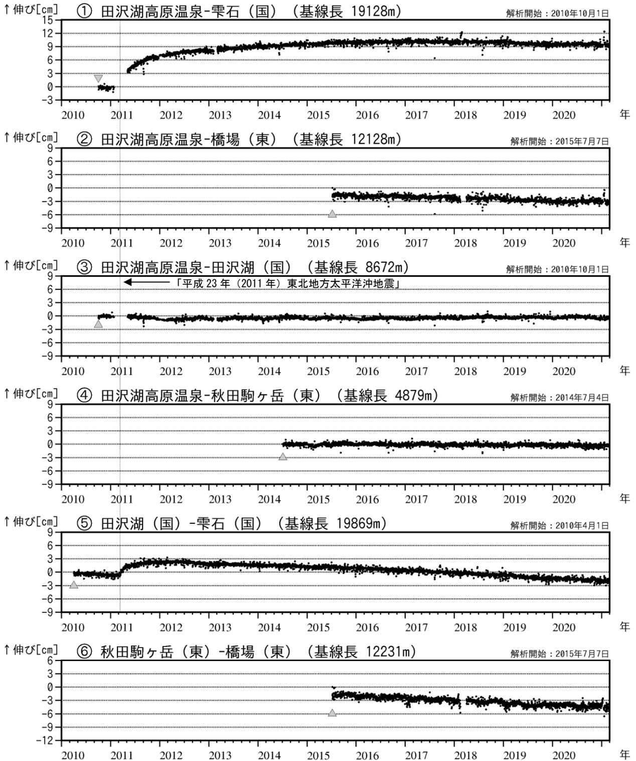
図5 秋田駒ヶ岳 GNSS 基線長変化図 (2010年4月～2021年2月)
