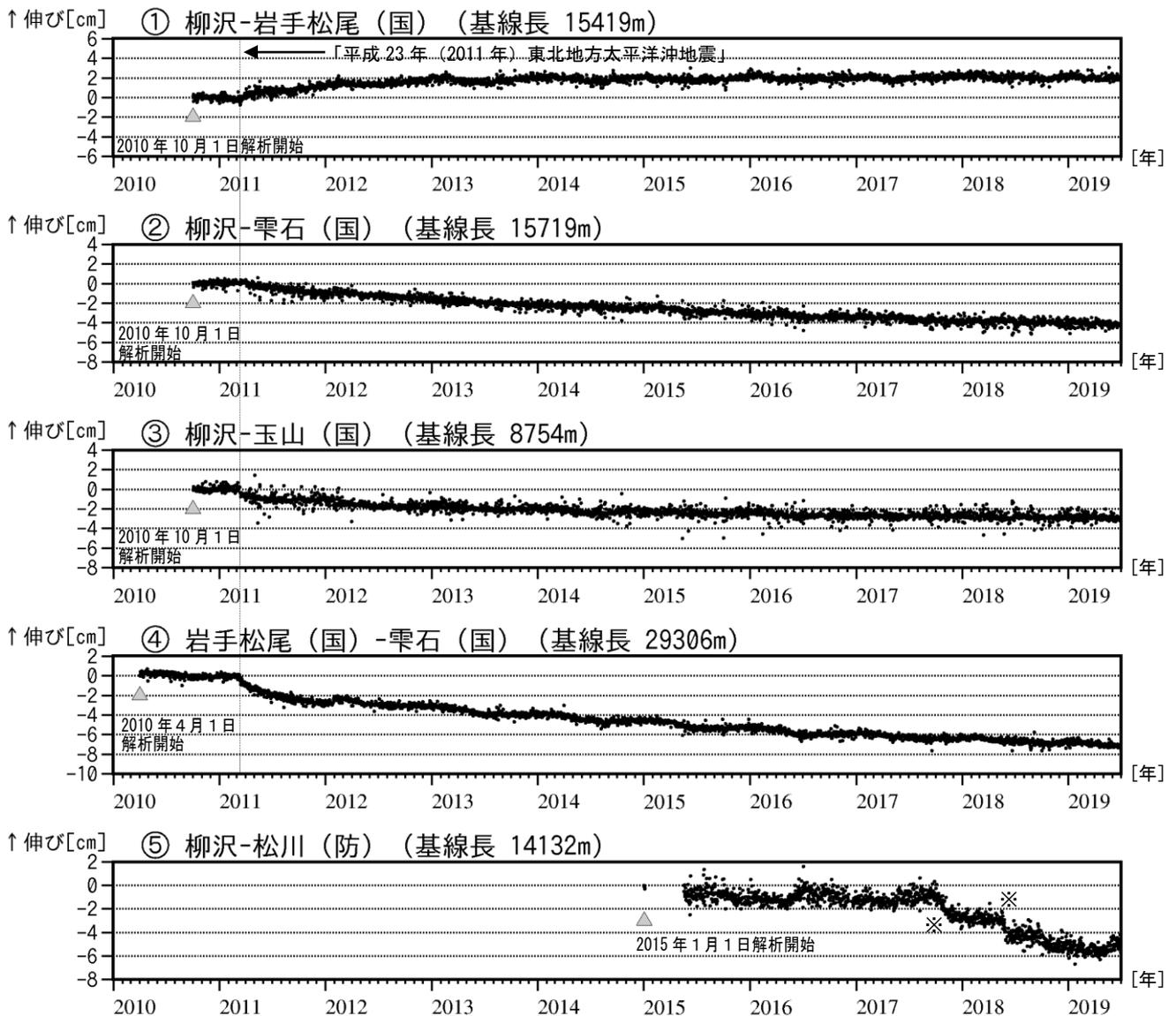
図9 岩手山 GNSS 基線長変化図（2010年4月～2019年6月）
