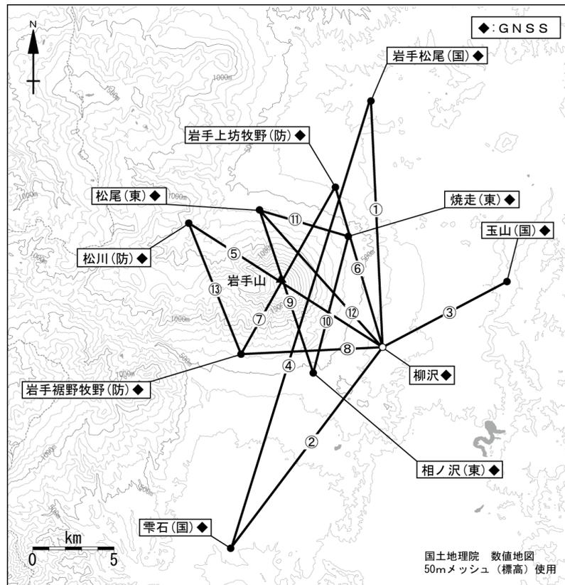
図 12 岩手山 GNSS 観測基線図
