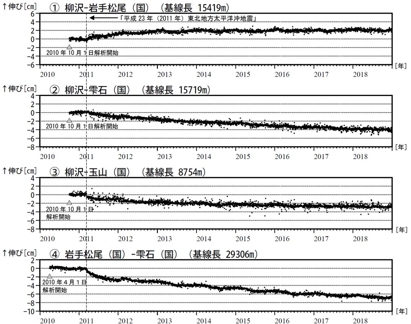
図5 岩手山 GNSS<sup>1)</sup> 基線長変化図（2010年4月～2018年12月）
