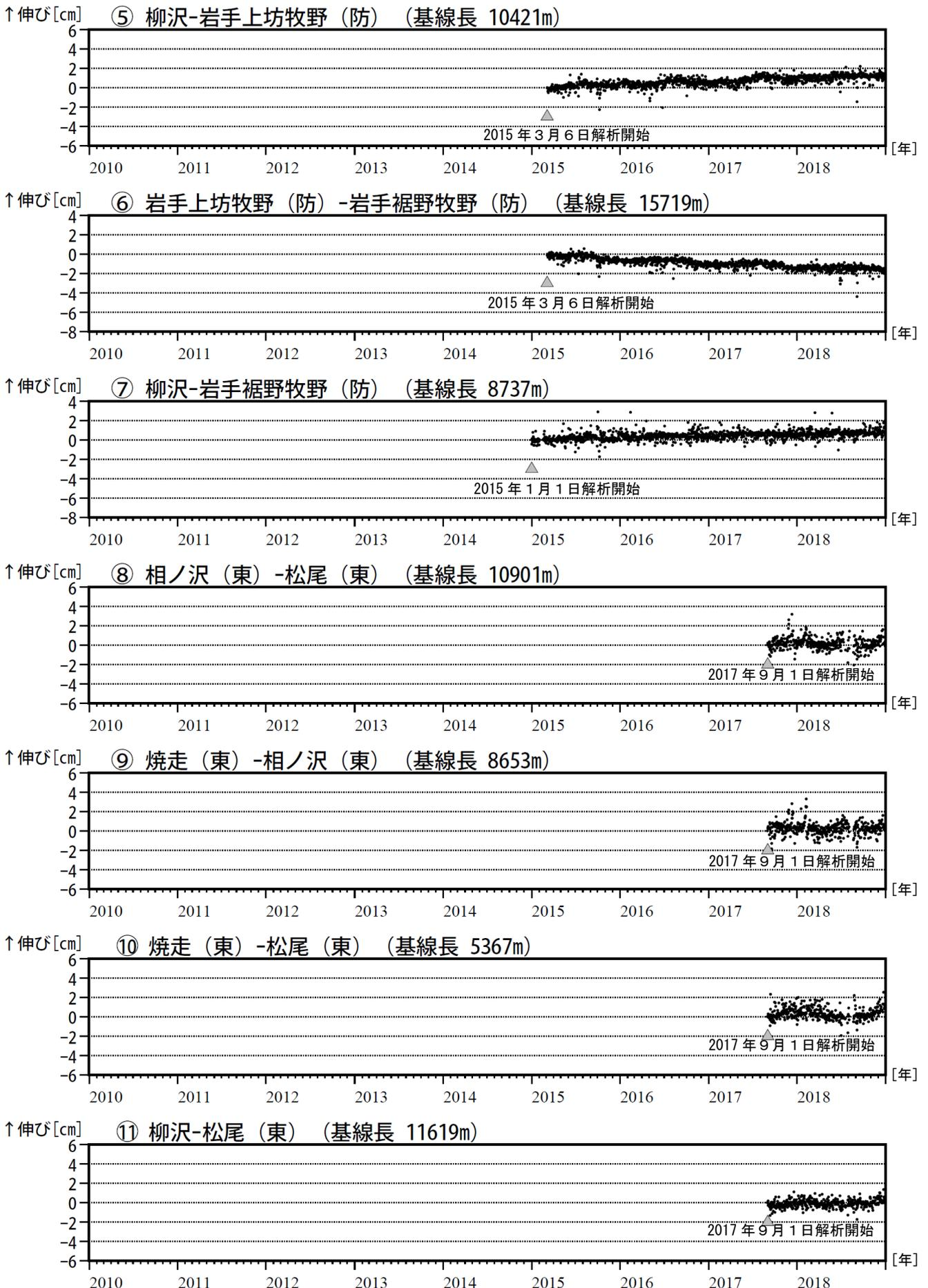
図6 岩手山 GNSS 基線長変化図 (2015年1月~2018年12月)
