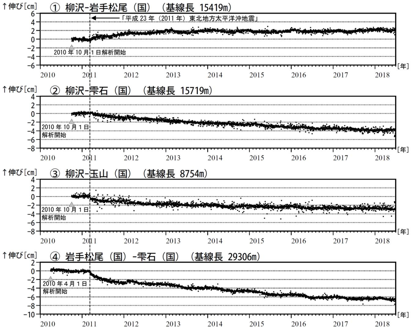
図10 岩手山 GNSS<sup>2)</sup> 基線長変化図（2010年4月～2018年6月）
