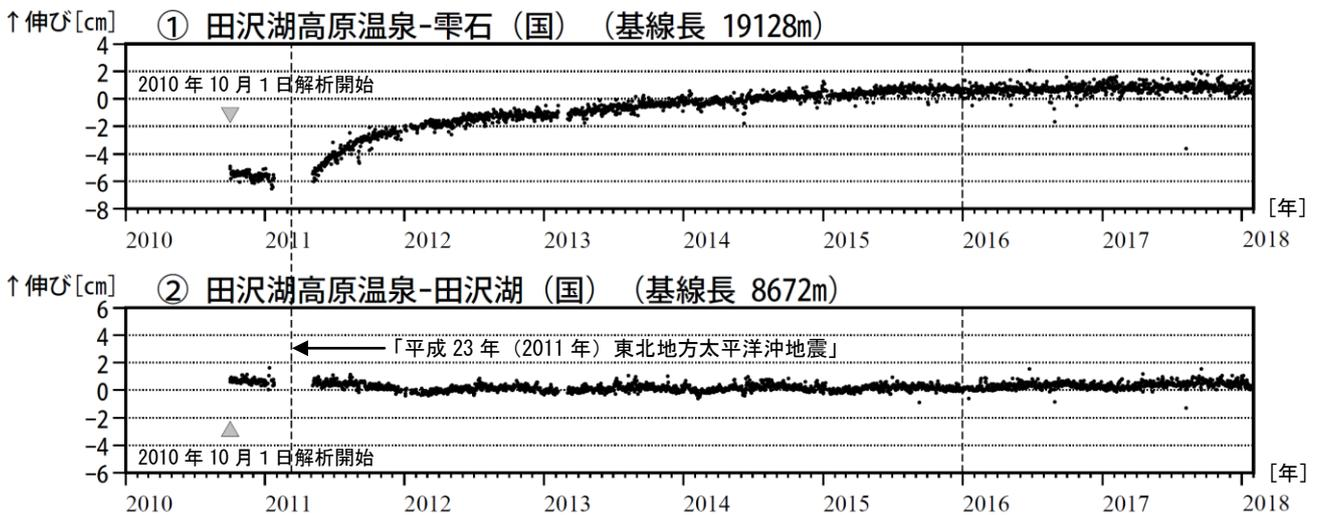
図3 秋田駒ヶ岳 GNSS<sup>1)</sup> 基線長変化図（2010年10月～2018年1月）
