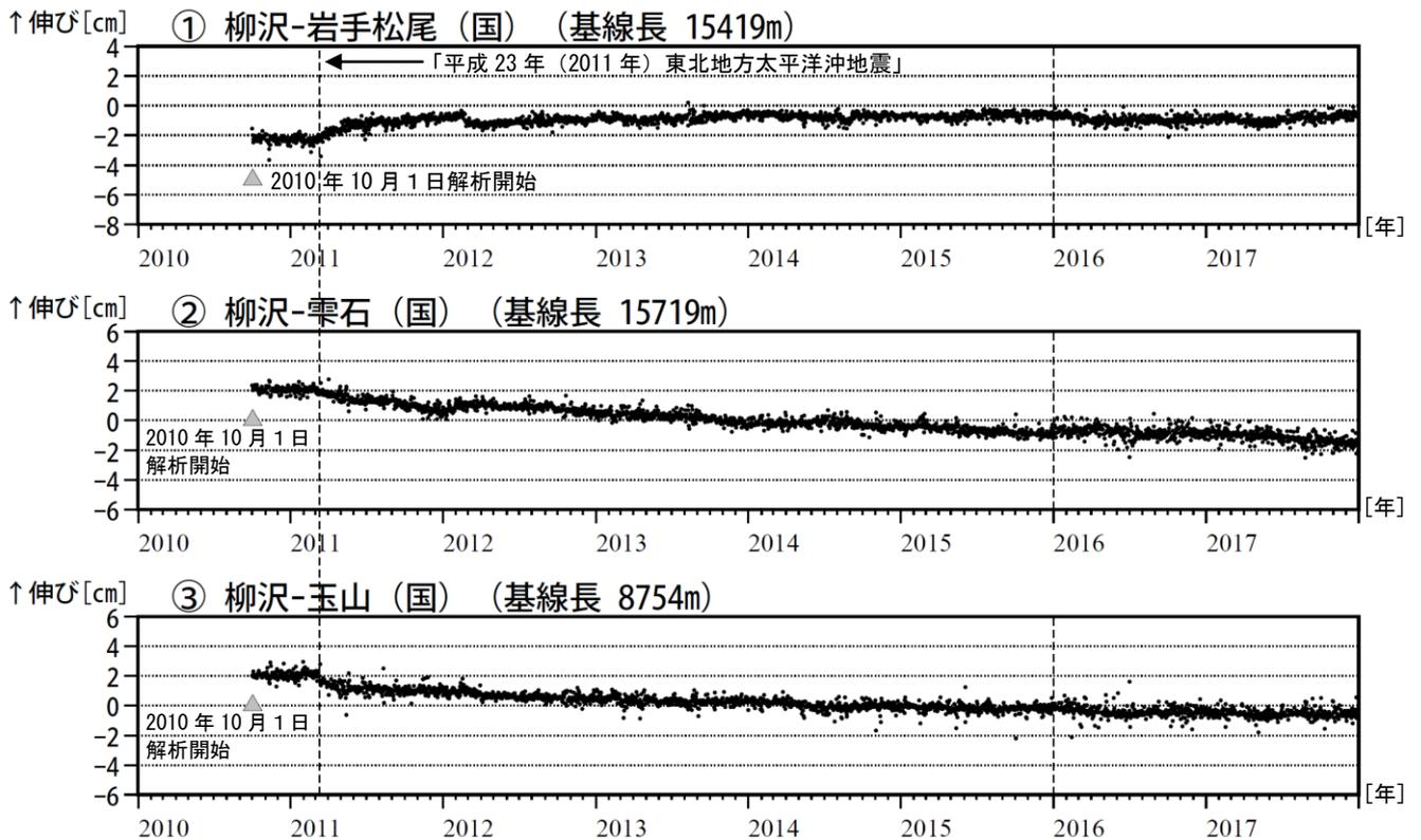
図4 岩手山 GNSS<sup>1)</sup> 基線長変化図（2010年10月～2017年12月）
