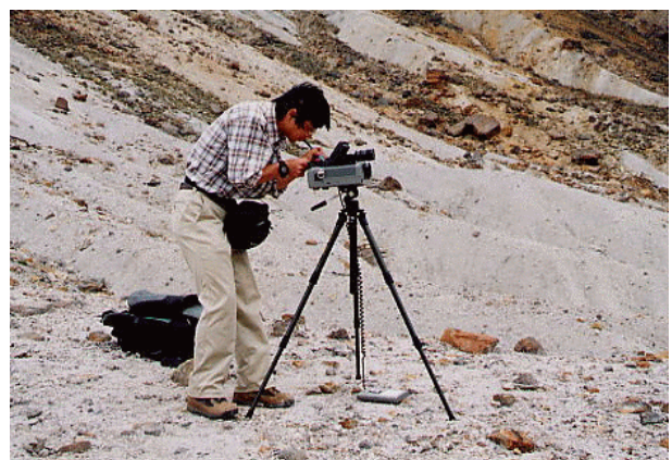
火山機動観測班による現地観測 (赤外熱映像装置による地熱地帯の観測)
