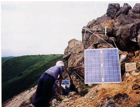
火山機動観測班による地震計の設置 (電力を確保するため、太陽電池パネルを利用している)
