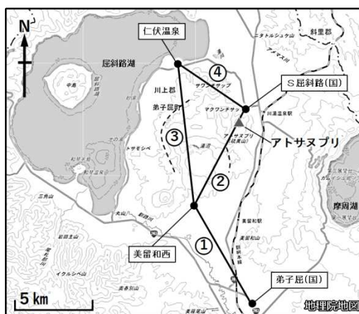
図3 アトサヌプリ GNSS連続観測による基線長変化(2010年10月~2021年5月)及び観測点配置図 ①~②の破線円内の変動(*1)は、美留和西観測点の局所的な動きによるもので、火山活動によるものではないと考えられます。 ①の破線円内の変動(*2)は、弟子屈(国)付近の樹木の影響及び伐採(2012年9月下旬)によるものです。 グラフの空白部分は欠測を示します。 *3 勝井義雄(1958)阿寒・屈斜路火山群、地球科学、39巻。 ・アトサヌプリカルデラを囲む基線②~④で収縮の変化が引き続き認められています。
