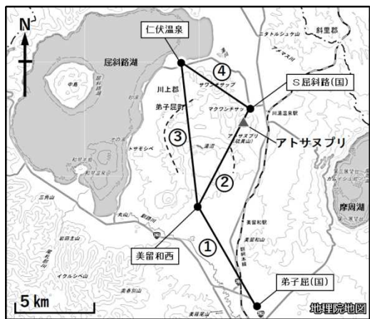
図3 アトサヌプリ GNSS連続観測による基線長変化（2010年10月～2021年3月）及び観測点配置図 ①～②の黒破線円内の変動（* 1）は、美留和西観測点の局所的な動きによるもので、火山活動によるものではないと考えられます。 ①の黒破線円内の変動（* 2）は、弟子屈(国)付近の樹木の影響及び伐採（2012年9月下旬）によるものです。 GNSS基線の空白部分は欠測を示します。 * 3 勝井義雄（1958）阿寒・屈斜路火山群、地球科学、39巻。 ・アトサヌプリカルデラを囲む基線②～④で収縮の変化が引き続き認められています。
