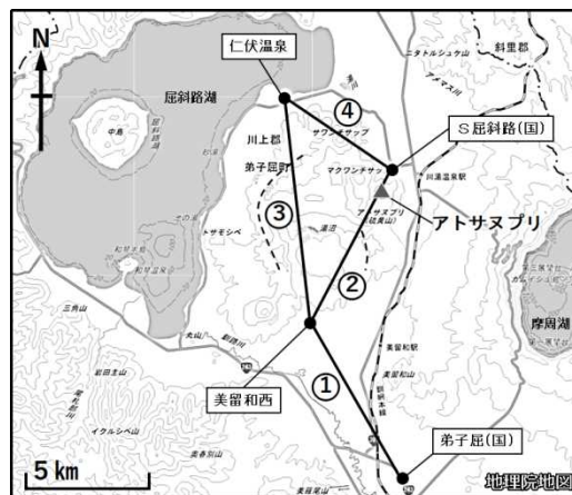
図3 アトサヌプリ GNSS連続観測による基線長変化（2010年10月～2021年2月）及び観測点配置図 ①～②の黒破線円内の変動（* 1）は、美留和西観測点の局所的な動きによるもので、火山活動によるものではないと考えられます。 ①の黒破線円内の変動（* 2）は、弟子屈(国)付近の樹木の影響及び伐採（2012年9月下旬）によるものです。 GNSS基線の空白部分は欠測を示します。 * 3 勝井義雄（1958）阿寒・屈斜路火山群、地球科学、39巻。 ・アトサヌプリカルデラを囲む基線②～④で収縮の変化が引き続き認められています。
