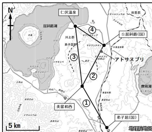
図3 アトサヌプリ GNSS連続観測による基線長変化（2010年10月～2020年5月）及び観測点配置図 ①～②の黒破線円内の変動（* 1）は、美留和西観測点の局所的な動きによるもので、火山活動によるものではないと考えられます。 ①の黒破線円内の変動（* 2）は、弟子屈(国)付近の樹木の影響及び伐採（2012年9月下旬）によるものです。 GNSS基線の空白部分は欠測を示します。 * 3 勝井義雄（1958）阿寒・屈斜路火山群、地球科学、39巻。 ・アトサヌプリカルデラを囲む基線②～④で収縮の変化が引き続き認められています。
