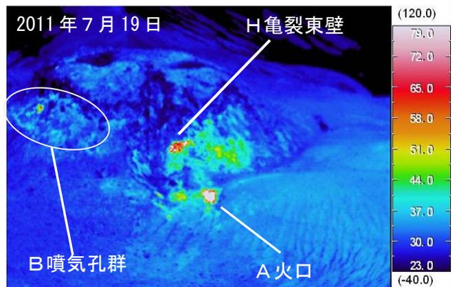
図4 樽前山 火口周辺、H亀裂周辺の地表面温度分布 南東側上空 (図2 矢印) から撮影
