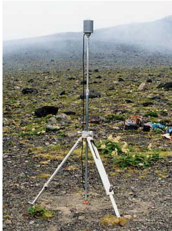
写真1 プロトン磁力計
