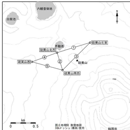
図6 霧島山（えびの高原（硫黄山）周辺） 図4及び図7のGNSS連続観測点と基線番号
