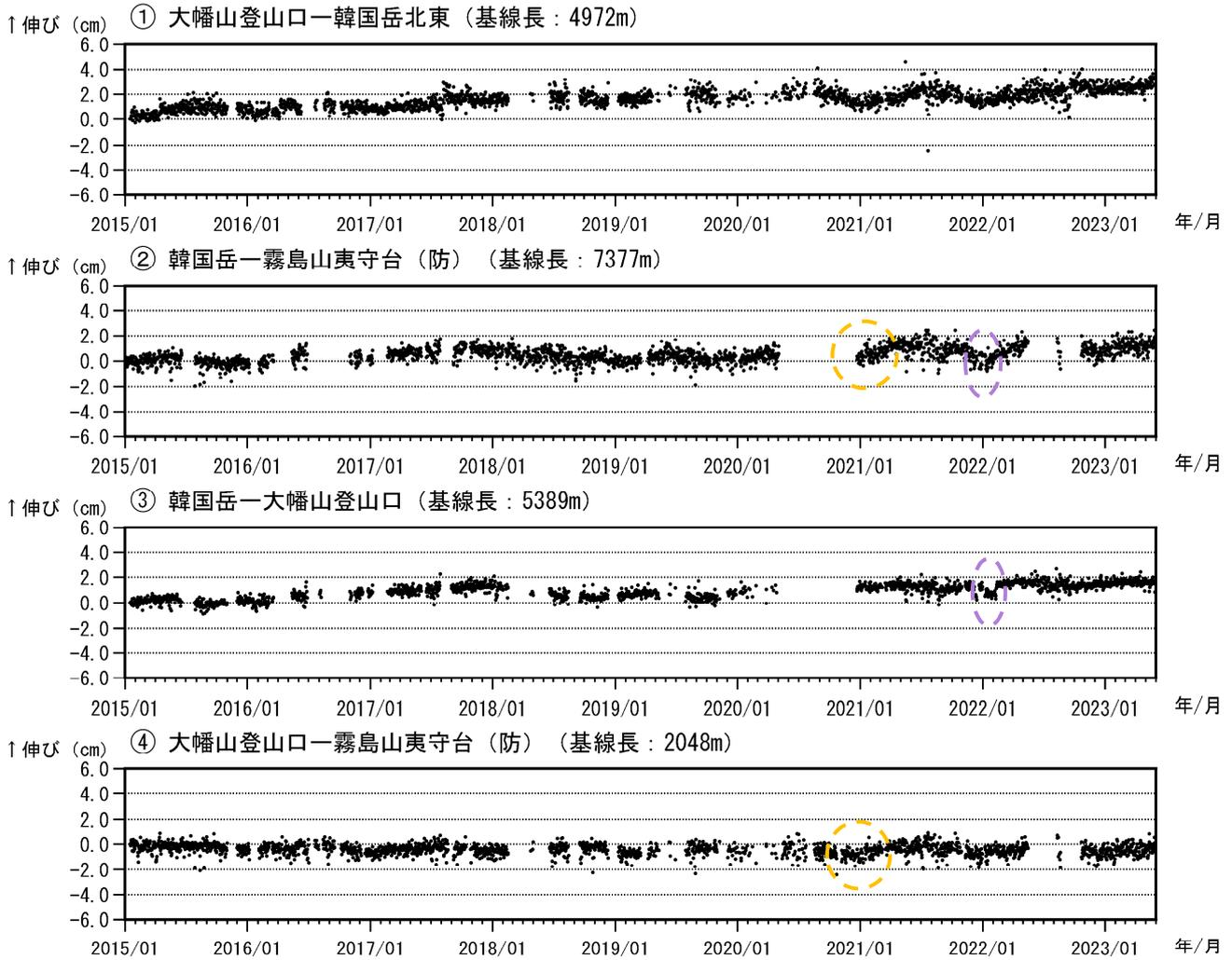
図4 霧島山（大幡池） GNSS 連続観測による基線長変化（2015年1月～2023年5月）
