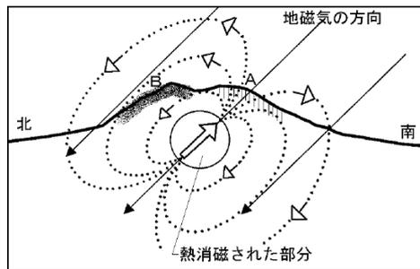
図 8-3 熱消磁に伴う全磁力変化のモデル
