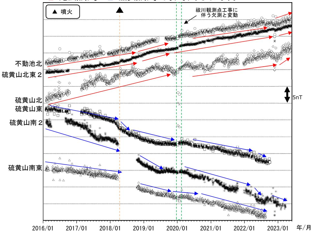
図 8-2 霧島山（えびの高原（硫黄山）周辺） 全磁力観測点で観測された全磁力変動（2016年1月～2023年5月）
