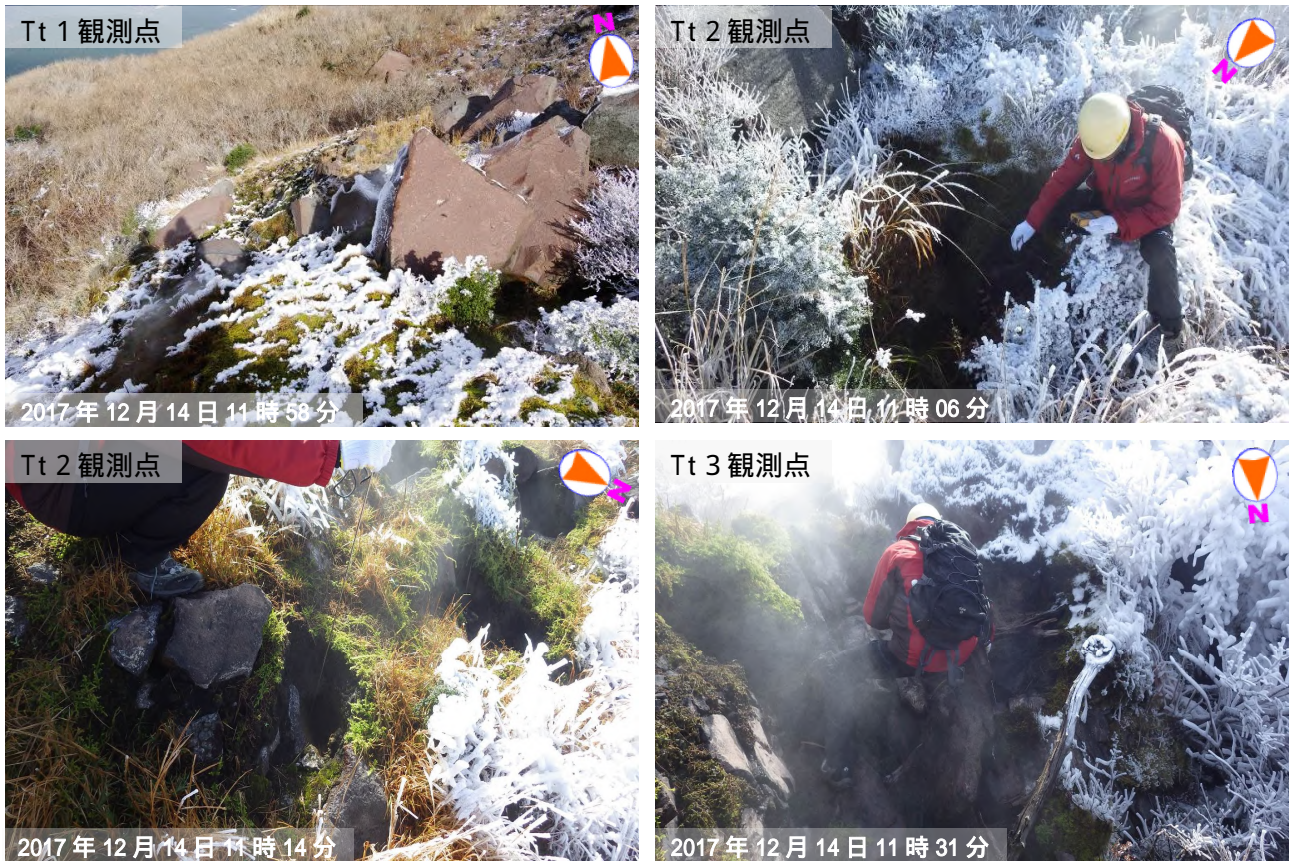
図5 雲仙岳 立岩の峰噴気地帯のサーミスタ温度計による測定状況 (Tt 1 ~ 3 における観測)
