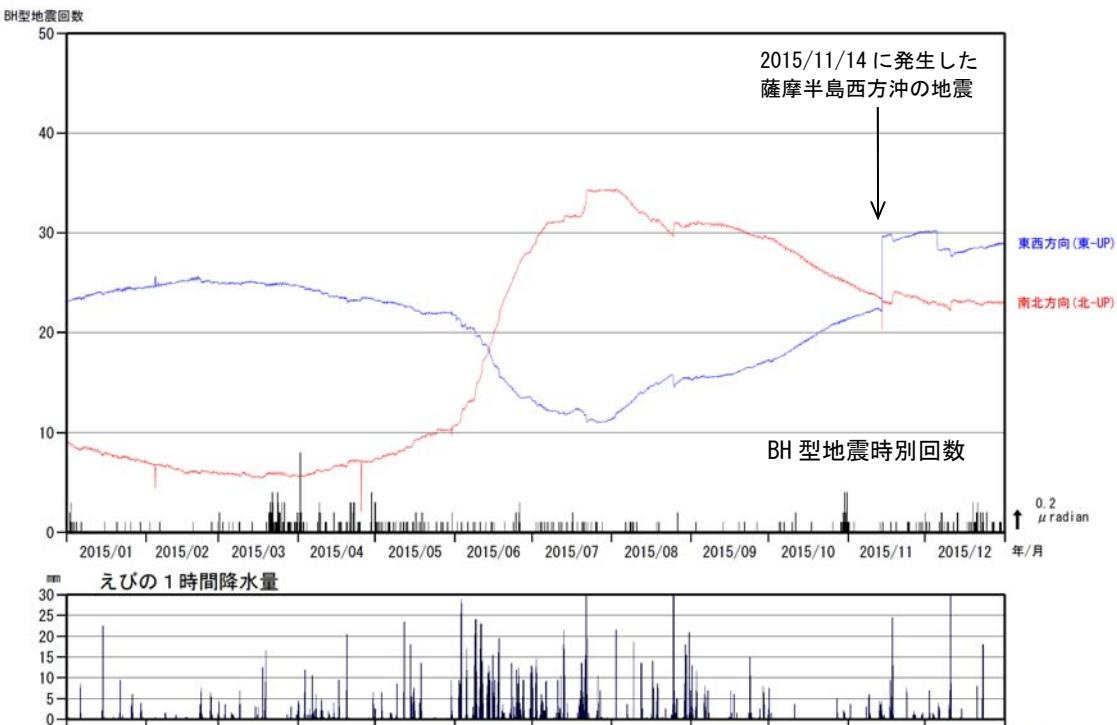
図4 霧島山（新燃岳） 高千穂河原傾斜計の変化、BH型地震の時間別回数
