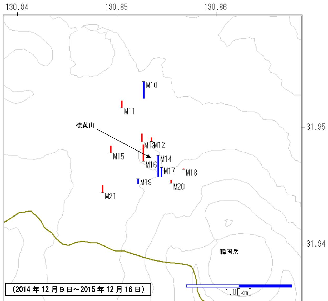
図 21-1 霧島山（えびの高原（硫黄山）周辺） 繰返し観測による全磁力変化
