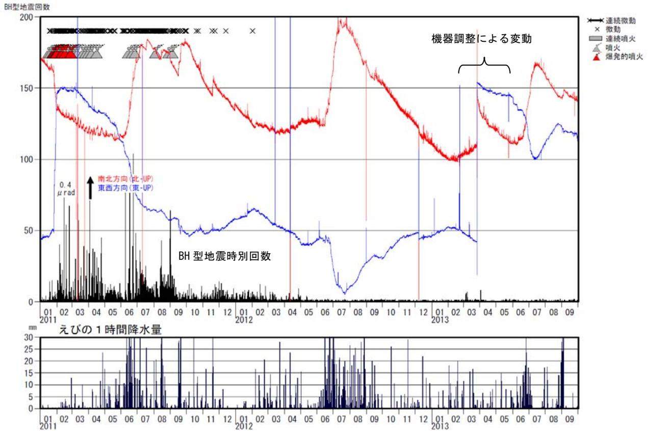
図3 霧島山（新燃岳）BH型地震<sup>2)</sup>の時間別回数と高千穂河原傾斜計（新燃岳の南東約3km）の変化（2011年1月～2013年9月30日）
