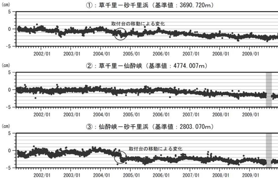
図 5 阿蘇山 GPS連続観測による基線長変化（2001 年 3 月～2009 年 12 月）
