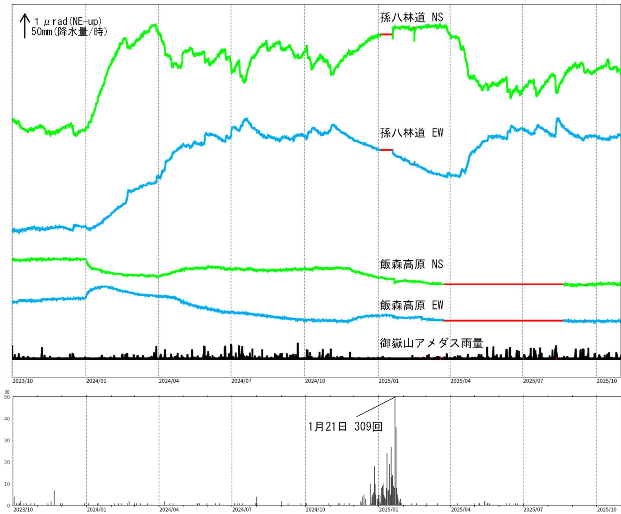
図7 御嶽山 傾斜変動と日別地震回数の推移（2023年10月1日～2025年10月31日）
