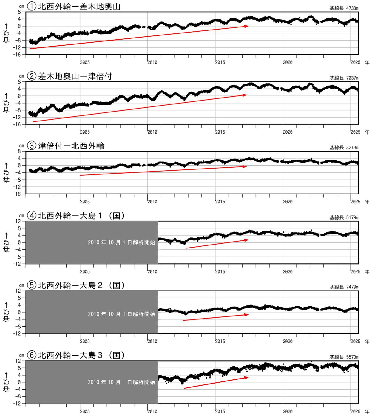
図3-1 伊豆大島 GNSS連続観測による基線長変化(2001年1月~2025年7月31日)
