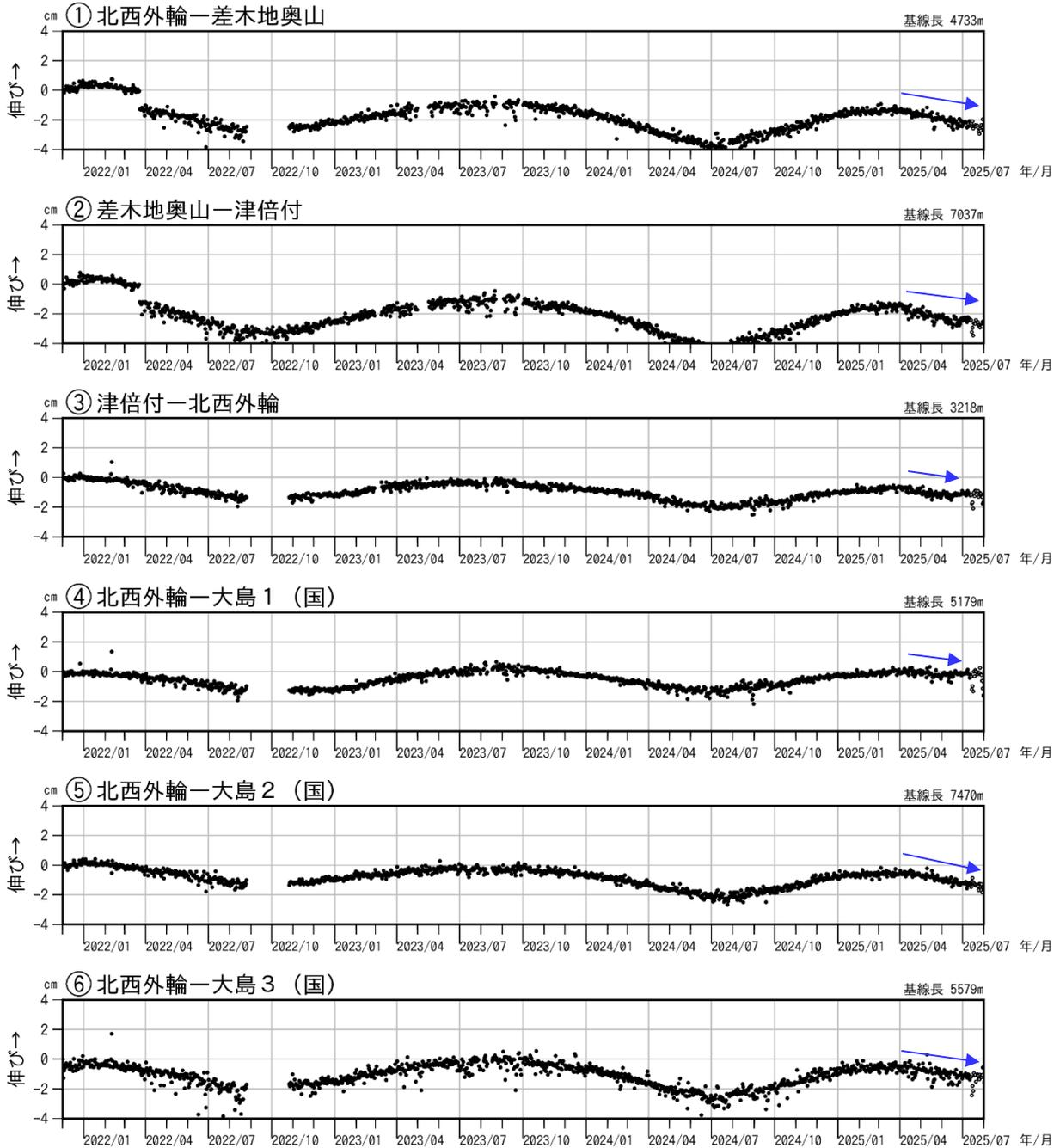
図3-2 伊豆大島 GNSS 連続観測による基線長変化(2021年12月~2025年7月31日)
