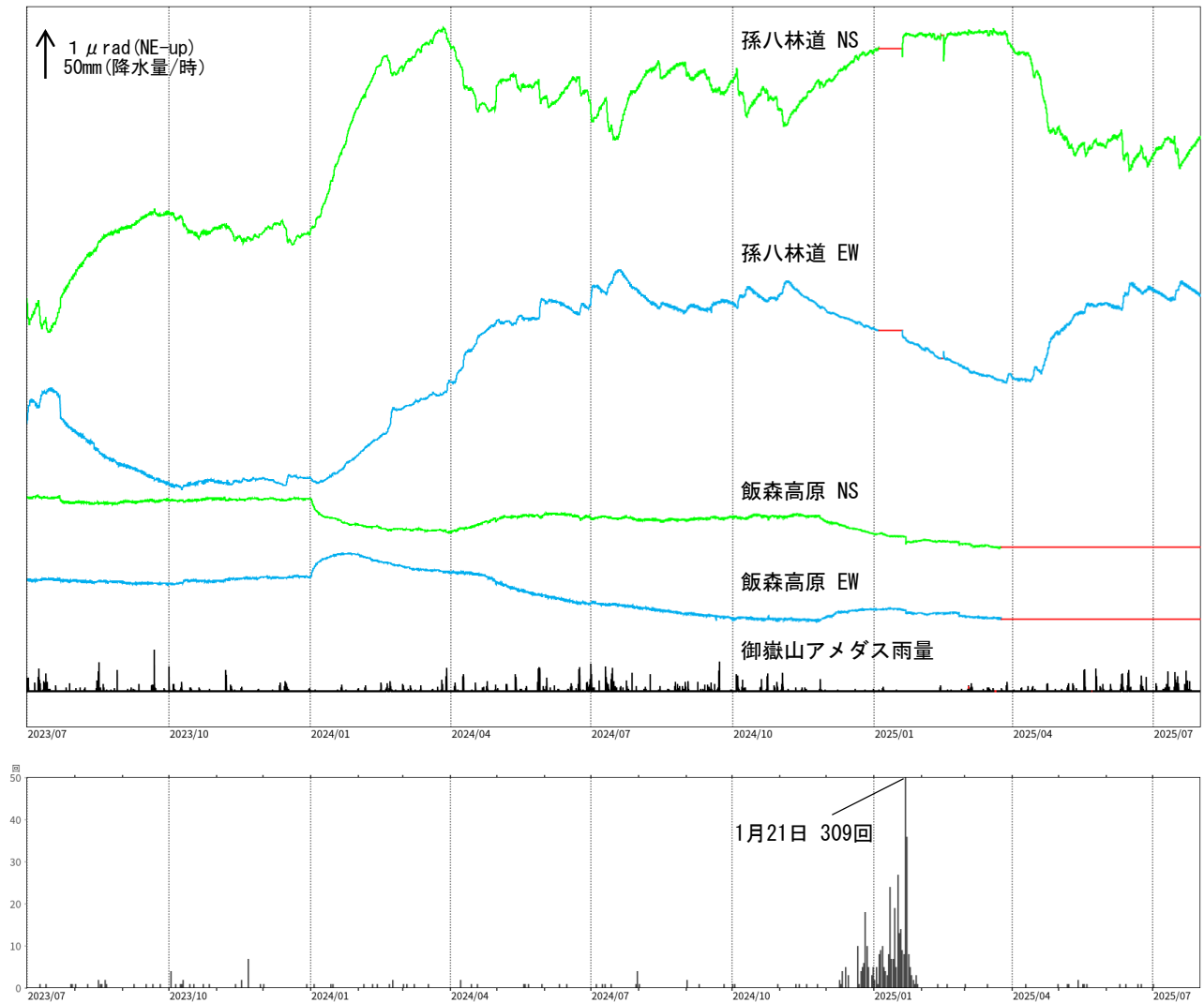
図7 御嶽山 傾斜変動と日別地震回数の推移（2023年7月1日～2025年7月31日） データは時間平均値で、孫八林道観測点のデータは潮汐補正済みです。 赤線部分は欠測を示します。 2024年1月以降、「令和6年能登半島地震」に伴うとみられる変動が認められます。
