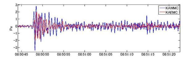
図8 浅間山 東京大学地震研究所による火口付近の観測点による空振データ(6月16日) ・6月16日08時50分、噴火に伴うとみられる空振を観測しました。 赤線は火口東側、青線は火口西側の空振データです。
