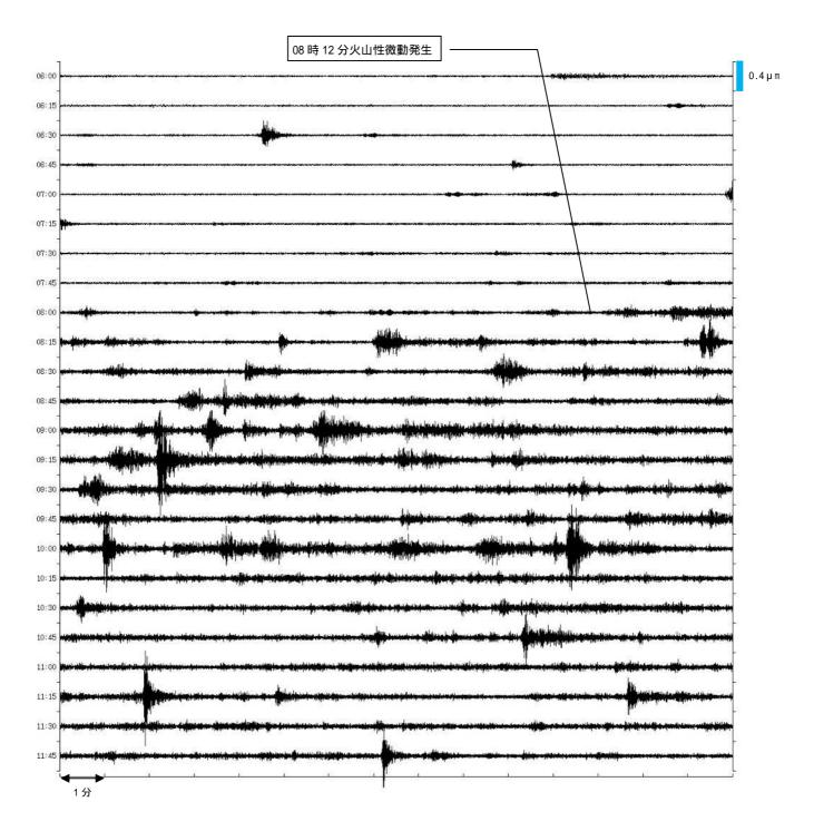
図7 浅間山 浅間石尊観測点における噴火発生前後の地震波形 6月16日06時00分~12時00分)
