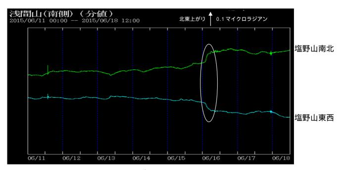
図 9 浅間山 塩野山傾斜計データ(6月11日00時~6月18日12時) ・16日02時頃から05時頃まで北西上がりの変化がみられました(白丸内)。 変動はその後停滞しています。
