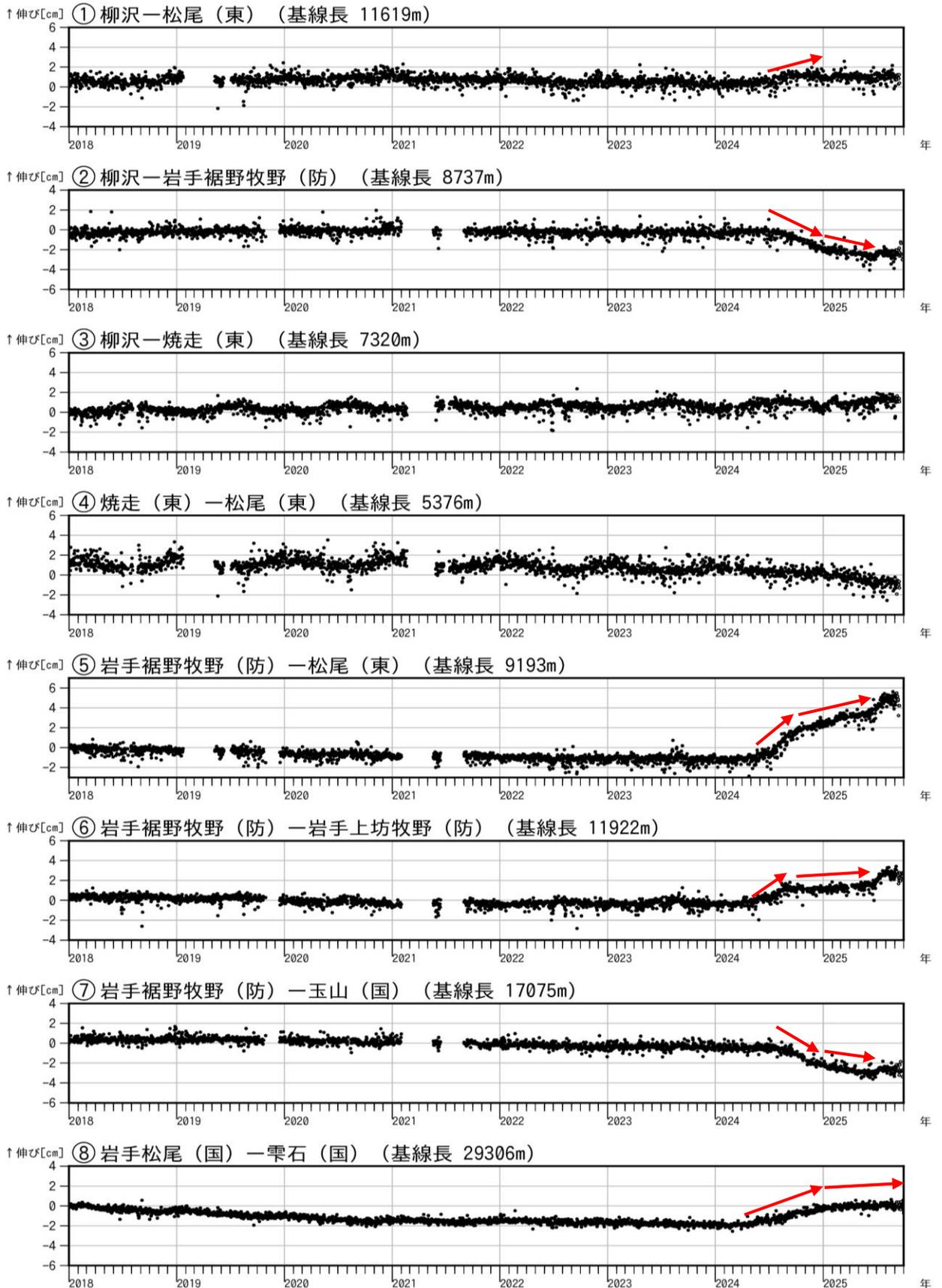
図 12 岩手山 GNSS 基線長変化図（2018 年 1 月～2025 年 9 月）
