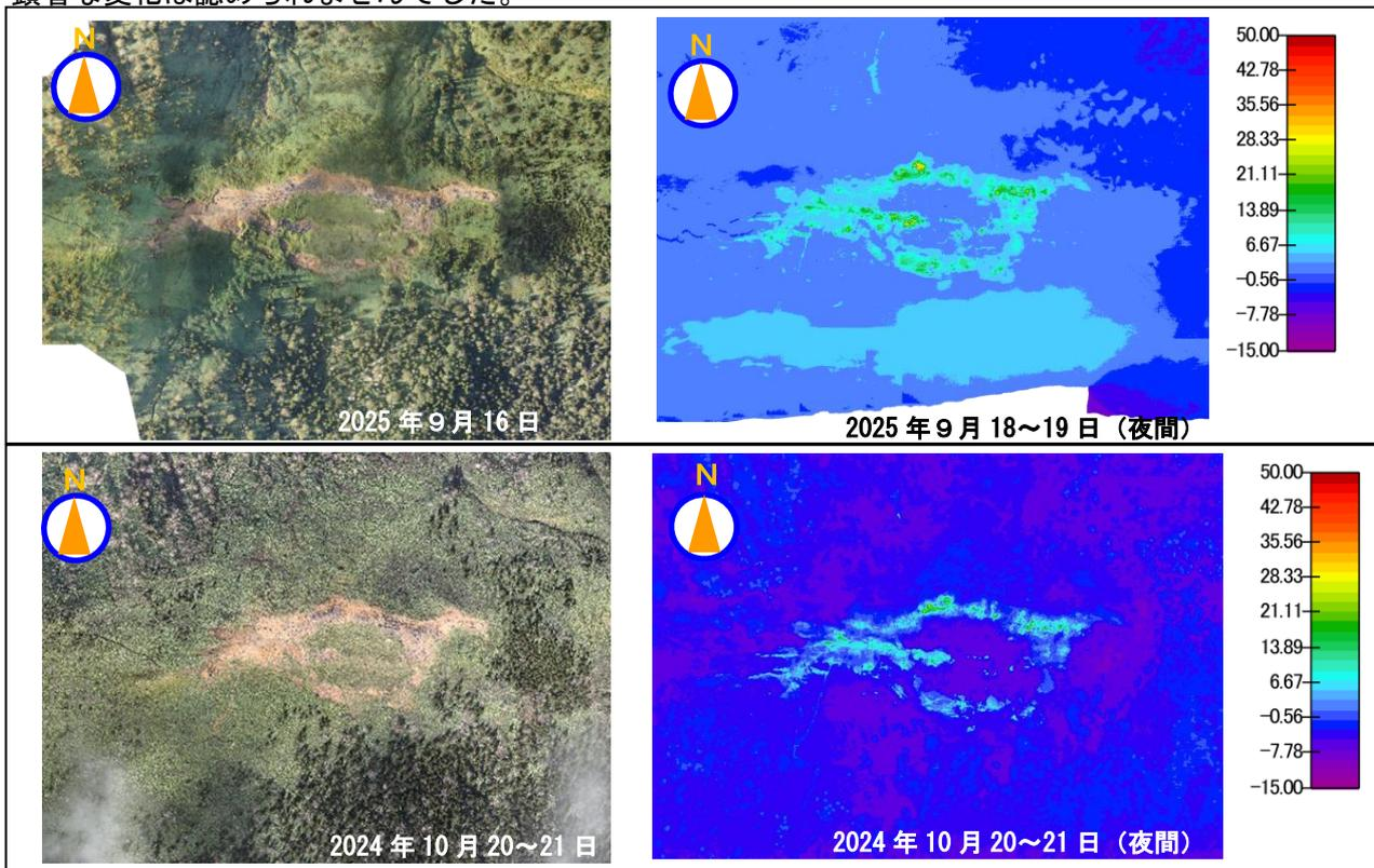
図11 岩手山 無人航空機（ドローン）で観測した上空からの黒倉山・姥倉山鞍部の状況と地表面温度分布
