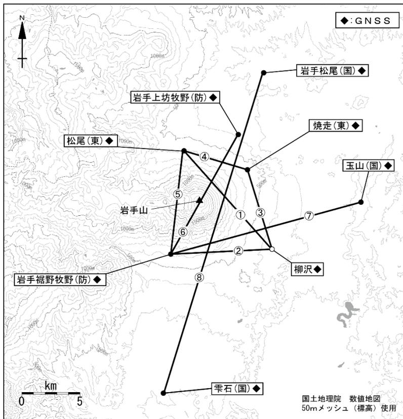
図15 岩手山 GNSS 観測基線図
