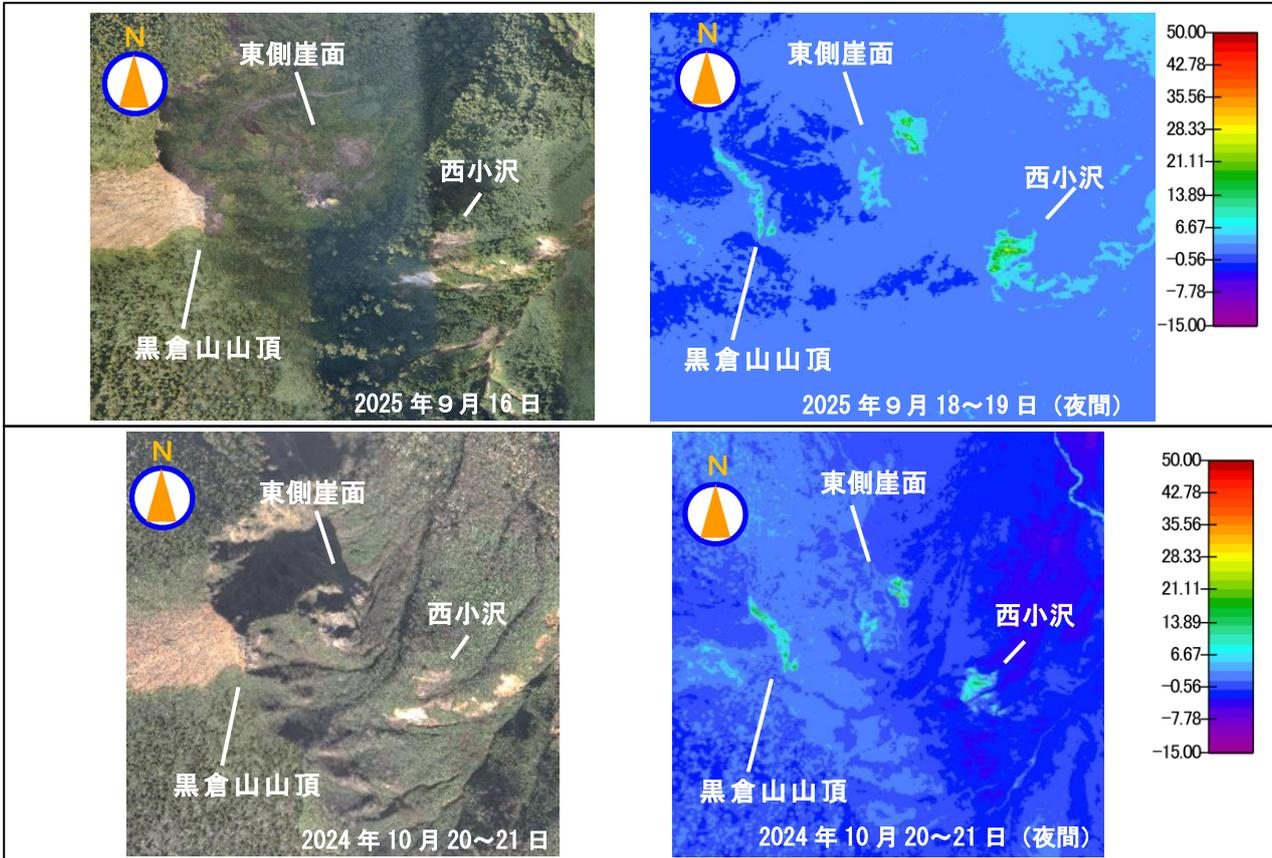
図10 岩手山 無人航空機（ドローン）で観測した上空からの黒倉山付近の状況と地表面温度分布
