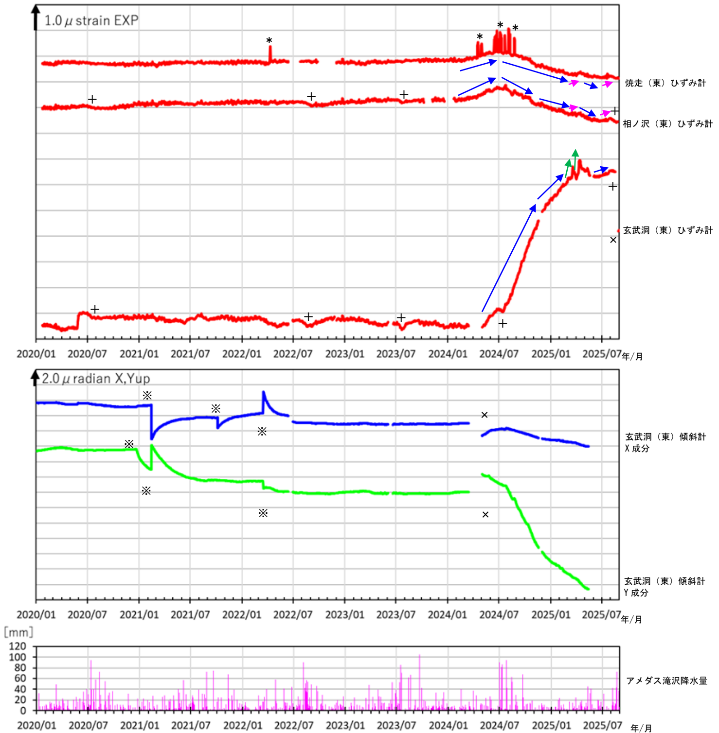
図10 岩手山 ひずみ計・傾斜計（日値・トレンド補正済み）による地殻変動の状況 （2020年1月～2025年8月）
