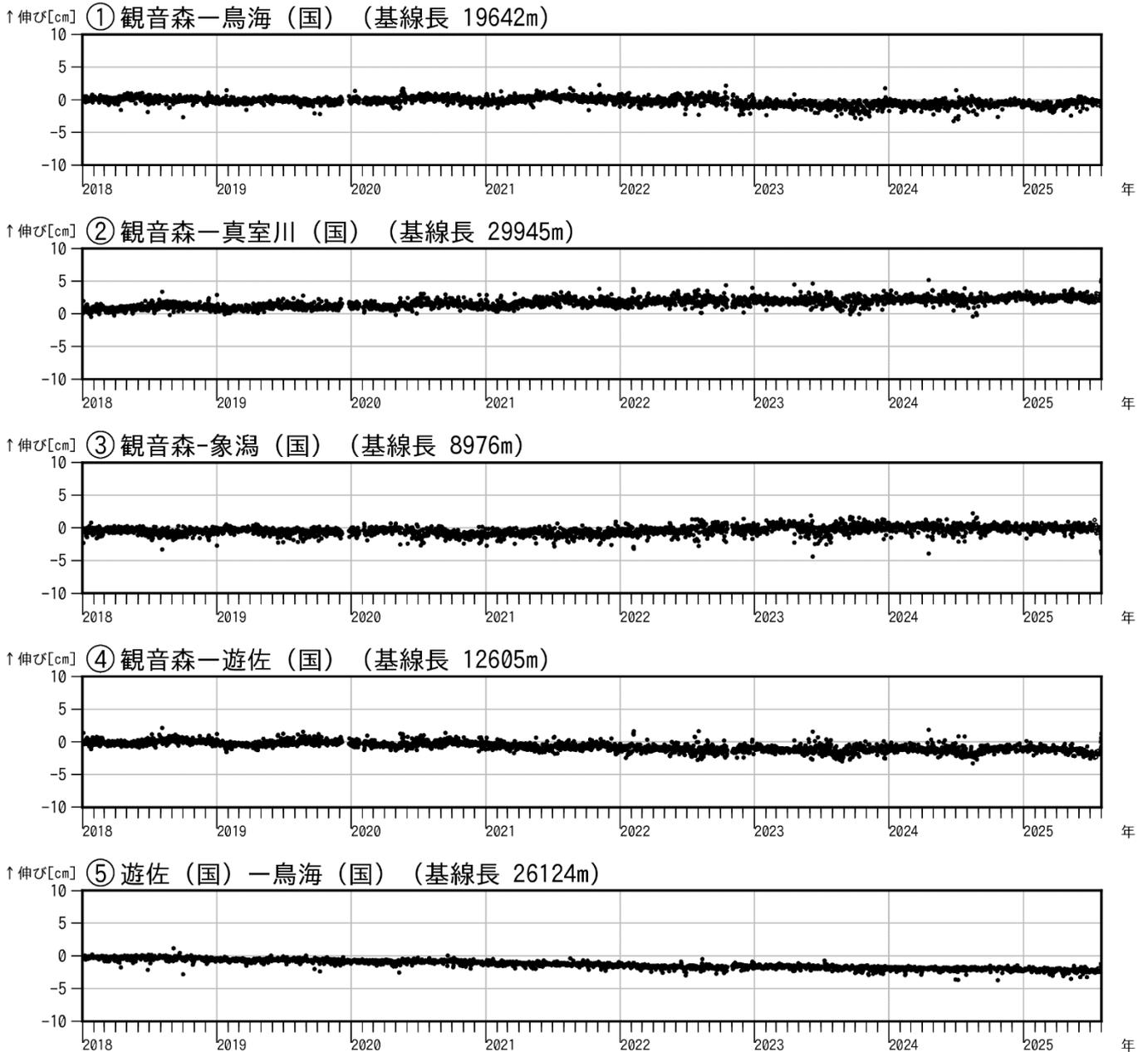
図4 鳥海山 GNSS 基線長変化図（2018年1月～2025年7月）
