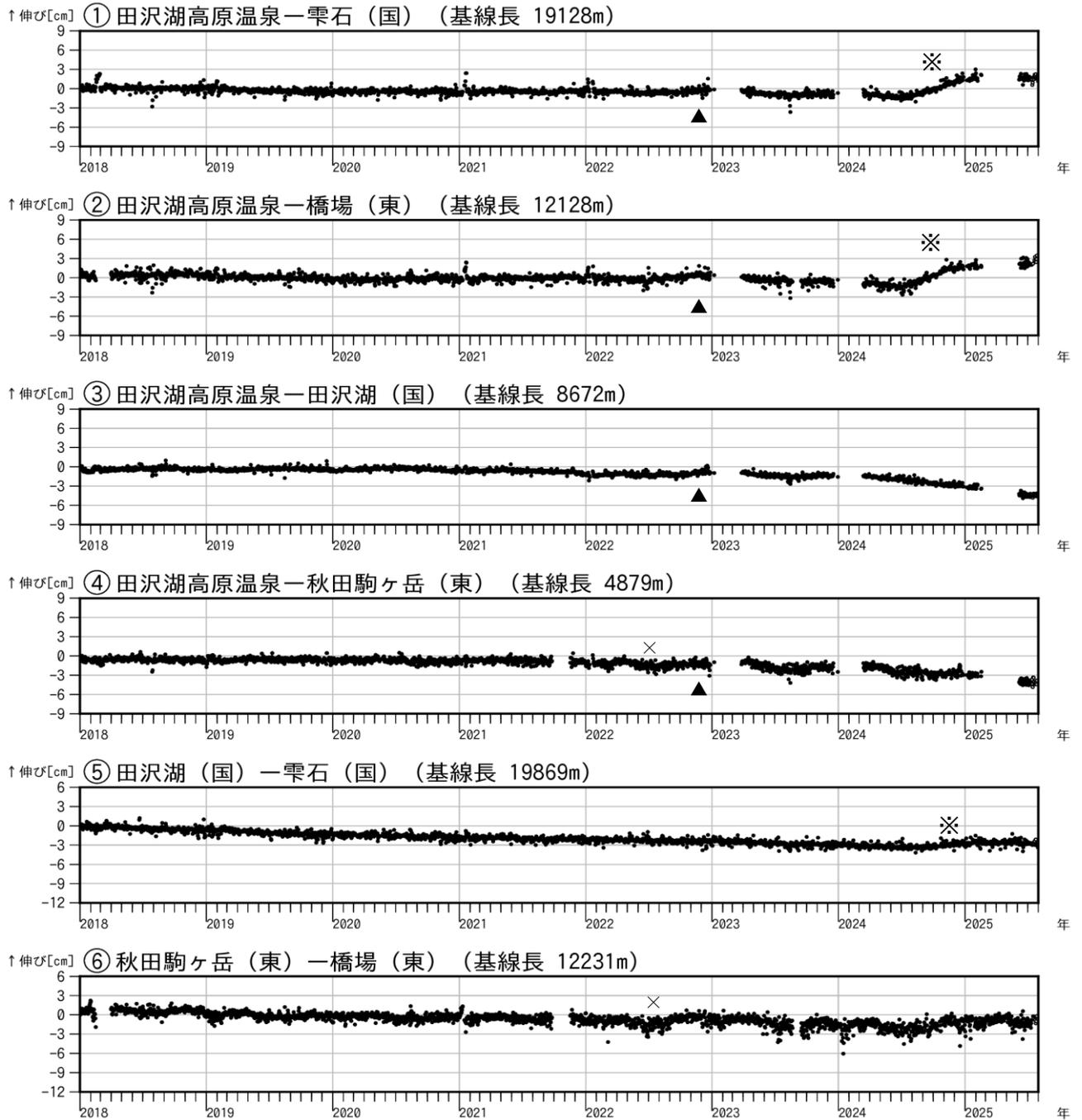
図5 秋田駒ヶ岳 GNSS 基線長変化図（2018年1月～2025年7月）
