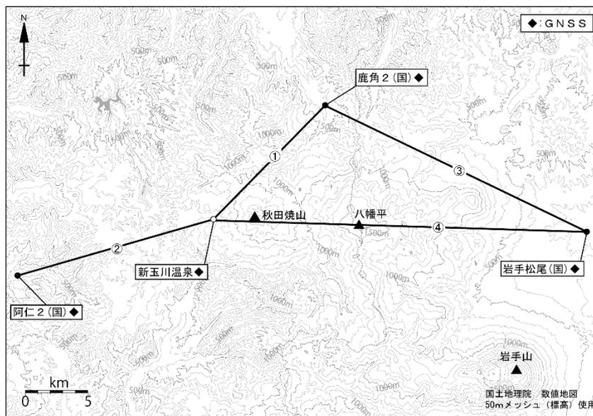
図6 秋田焼山 GNSS 観測基線図
