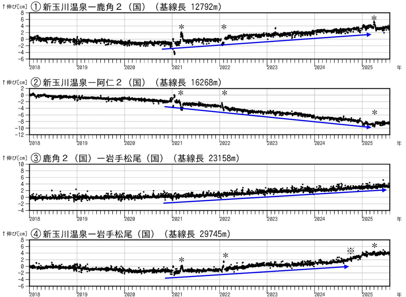
図4 秋田焼山 GNSS 基線長変化図（2018年1月～2025年7月）
