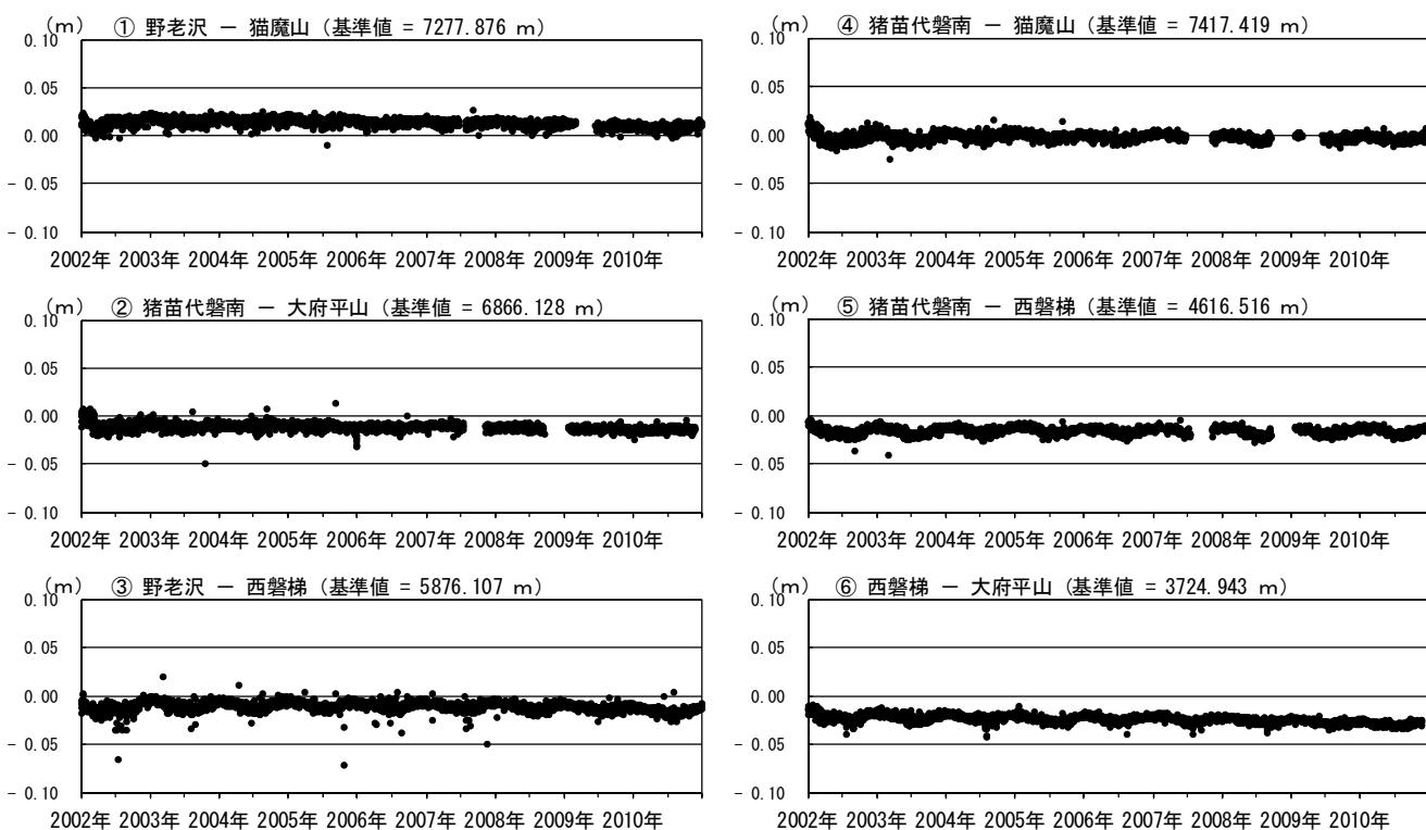
図 11 磐梯山 GPS 基線長変化図 (2002 年 1 月～2010 年 12 月)
