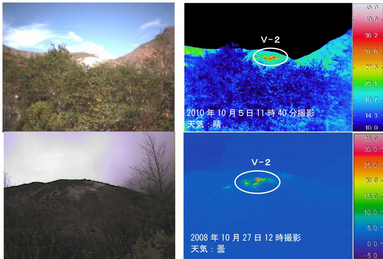
図7 磐梯山 沼ノ平(V-2)の可視画像(左)と地表面温度分布<sup>1)</sup>(右)
