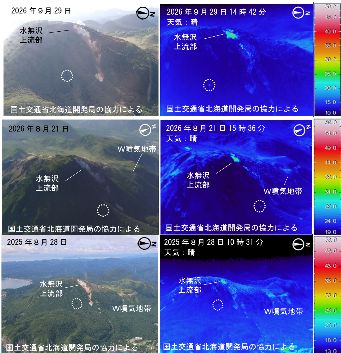
図6 恵山 赤外熱映像装置による水無沢上流部の地表面温度分布
