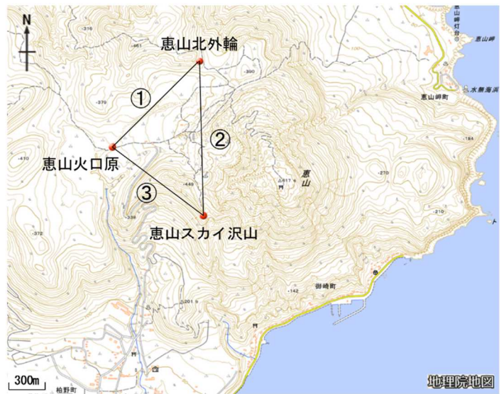
図3 恵山 GNSS 繰り返し観測による基線長変化及び観測点配置図（2005年8月～2021年11月） ・2019年から2020年に認められた基線長のわずかな伸長の変化は、今回の観測では確認されませんでした。
