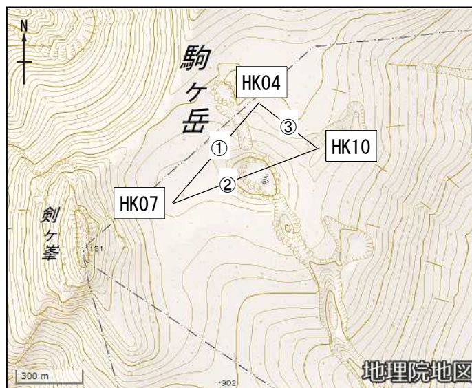
図18 北海道駒ヶ岳 GNSS繰り返し観測による火口付近の基線長変化 (2002年4月～2025年5月) 及び観測点配置図
