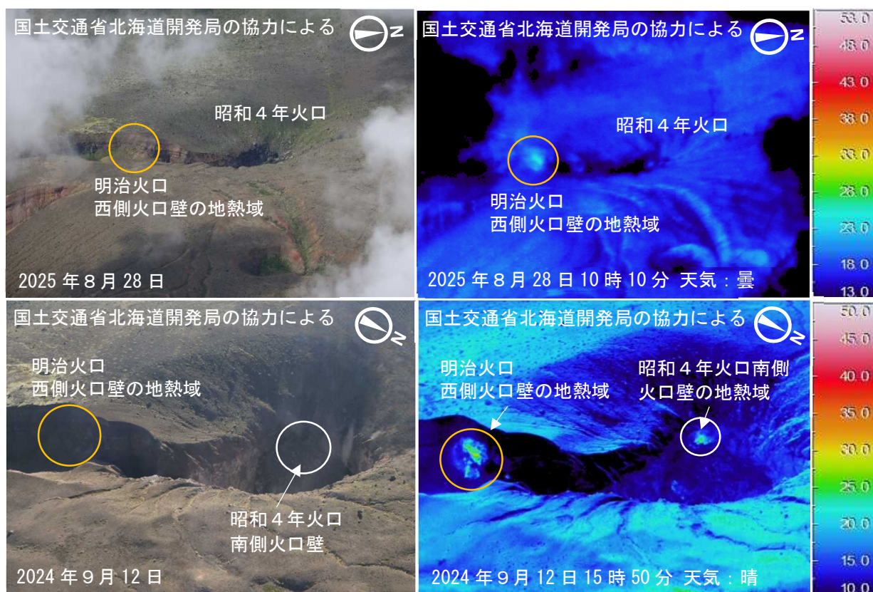
図 7 北海道駒ヶ岳 昭和4年火口及び明治火口の地表面温度分布 上：東側上空（図5の②）から撮影、下：東側上空（図5の③）から撮影 ・ 明治火口西側火口壁に弱い地熱域（橙円内）を引き続き確認しました。 ・ 昭和4年火口南側火口壁の地熱域は、観測条件が悪く確認できませんでした。
