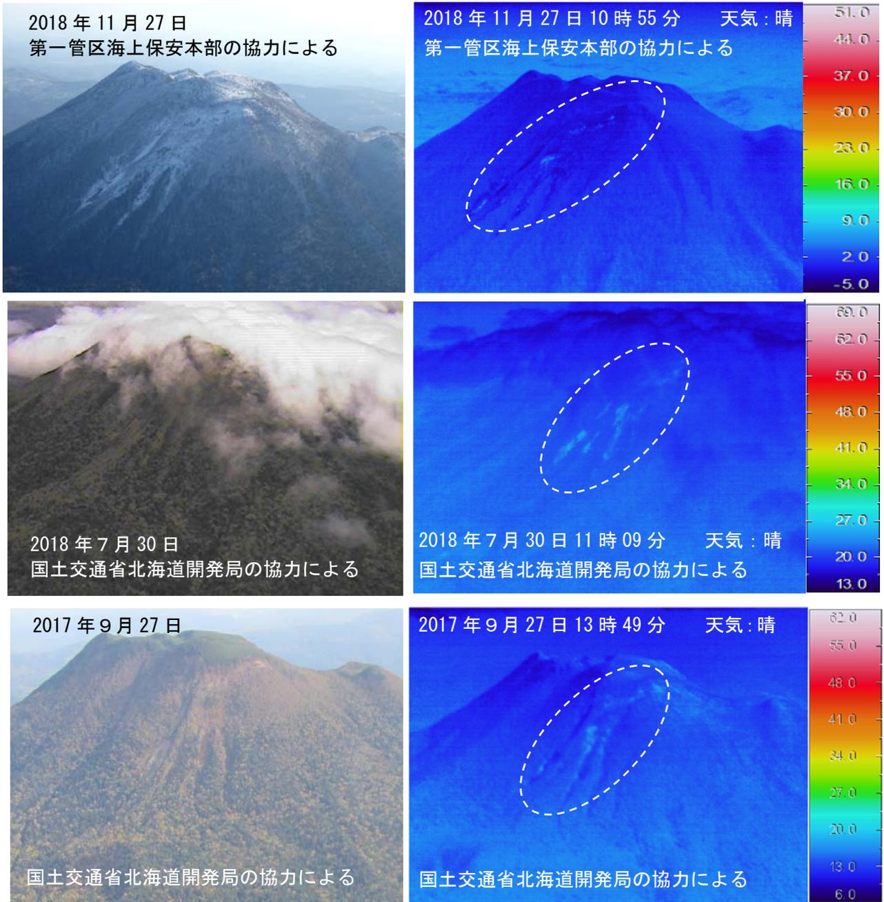
図2 雄阿寒岳 赤外熱映像装置による北西斜面の地表面温度分布の比較
