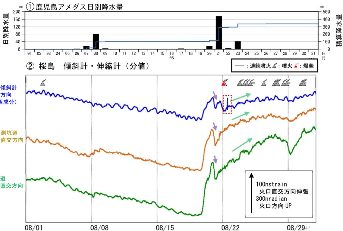
図6 桜島 傾斜計及び伸縮計による地殻変動の状況（2025年8月1日～8月31日）
