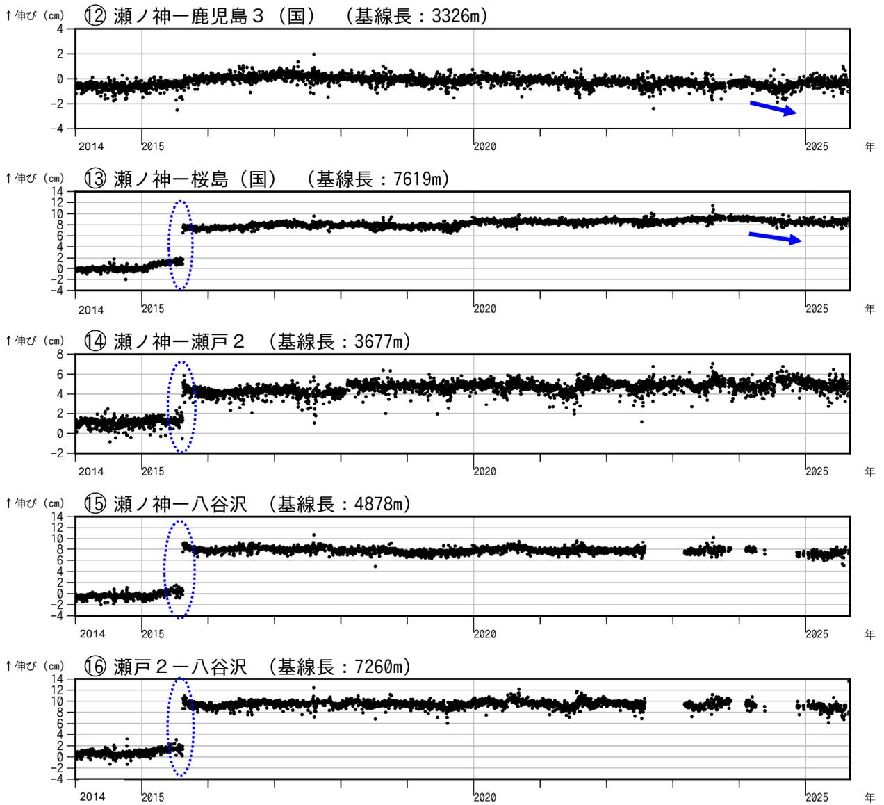
図 7-3 桜島 GNSS 連続観測による基線長変化（2014 年 1 月～2025 年 8 月）
