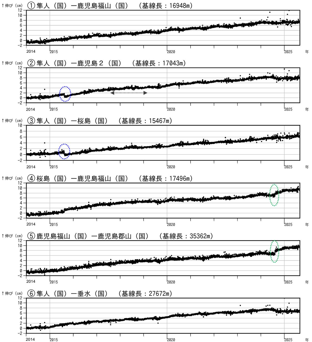
図 7-1 桜島 GNSS 連続観測による基線長変化（2014 年 1 月～2025 年 8 月）
