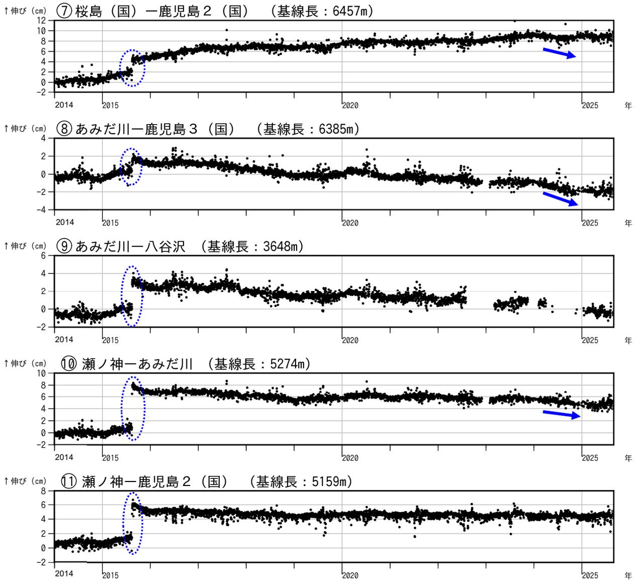
図 7-2 桜島 GNSS 連続観測による基線長変化（2014 年 1 月～2025 年 8 月）
