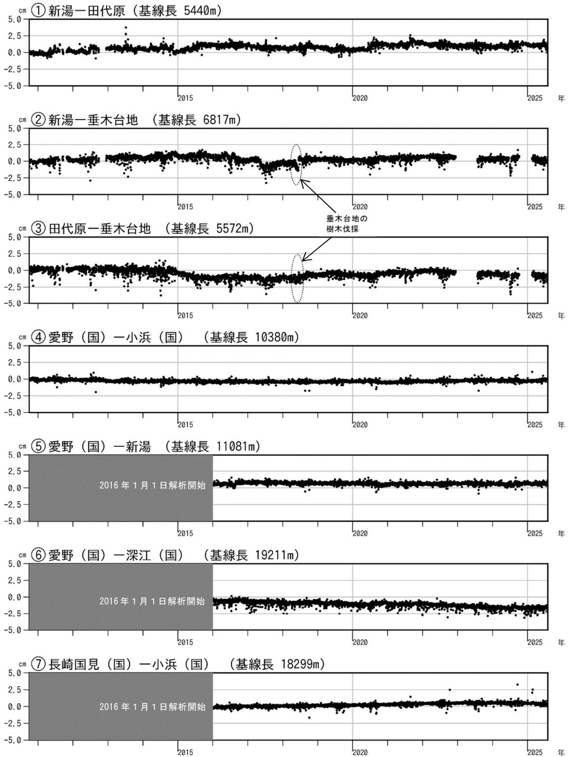
図5 雲仙岳 GNSS連続観測による基線長変化（2010年10月～2025年7月）
