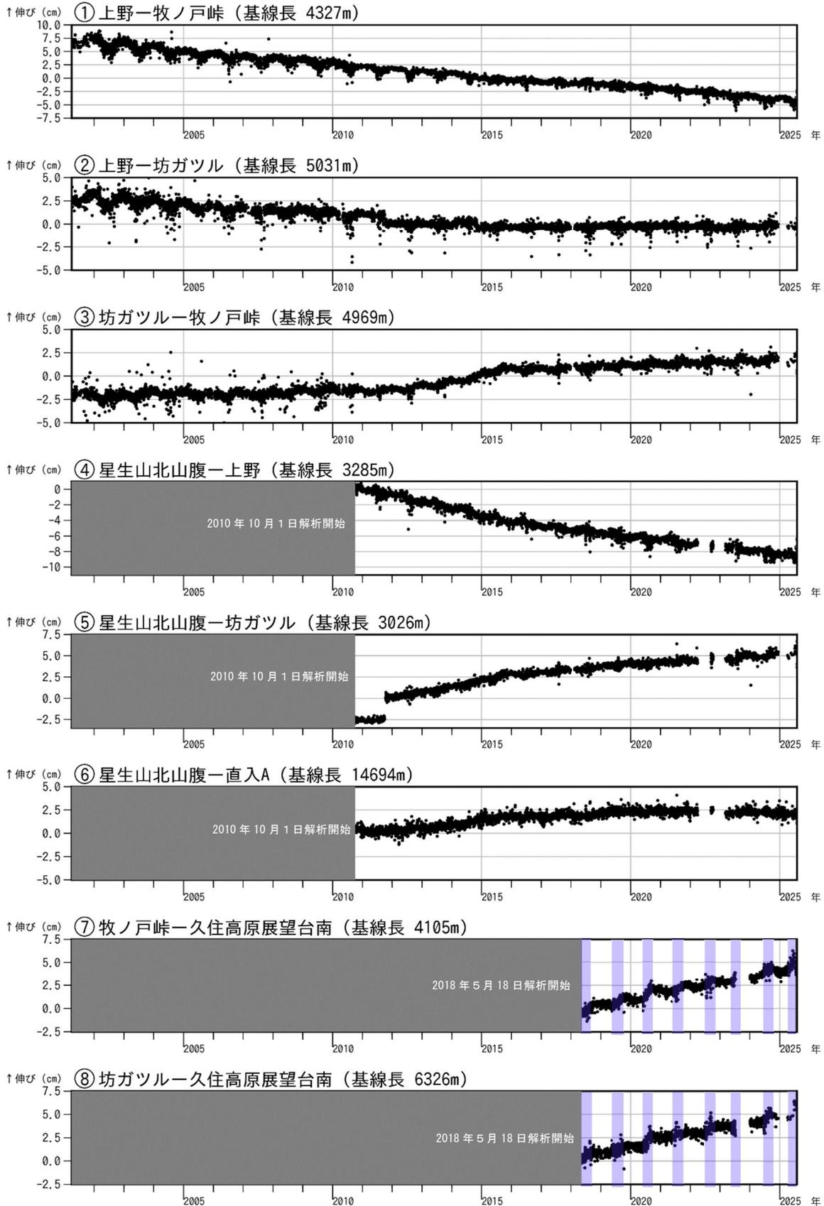
図5 九重山 GNSS連続観測による基線長変化（2001年4月～2025年7月）
