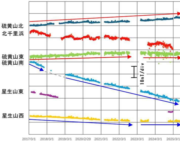
図 4-1 九重山 連続観測による全磁力の変化
