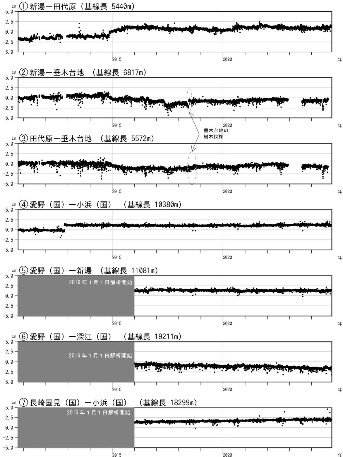
図7 雲仙岳 GNSS連続観測による基線長変化（2010年10月～2024年11月）
