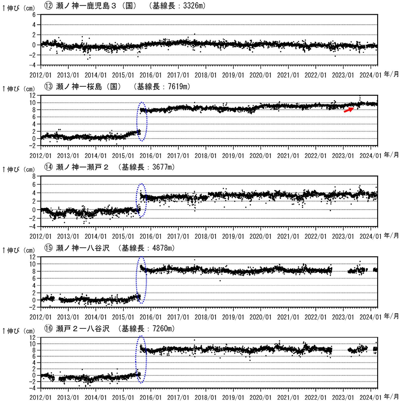
図 9-3 桜島 GNSS 連続観測による基線長変化 (2012 年 1 月～2024 年 3 月)
