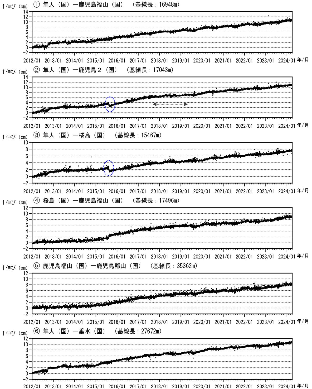
図 9-1 桜島 GNSS 連続観測による基線長変化（2012年1月～2024年3月）
