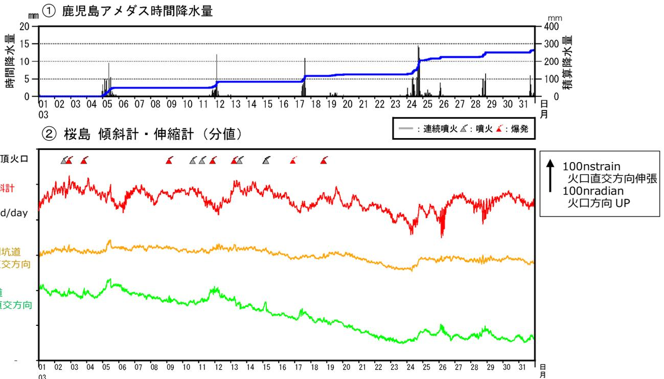
図8 桜島 傾斜計及び伸縮計による地殻変動の状況（2024年3月）
