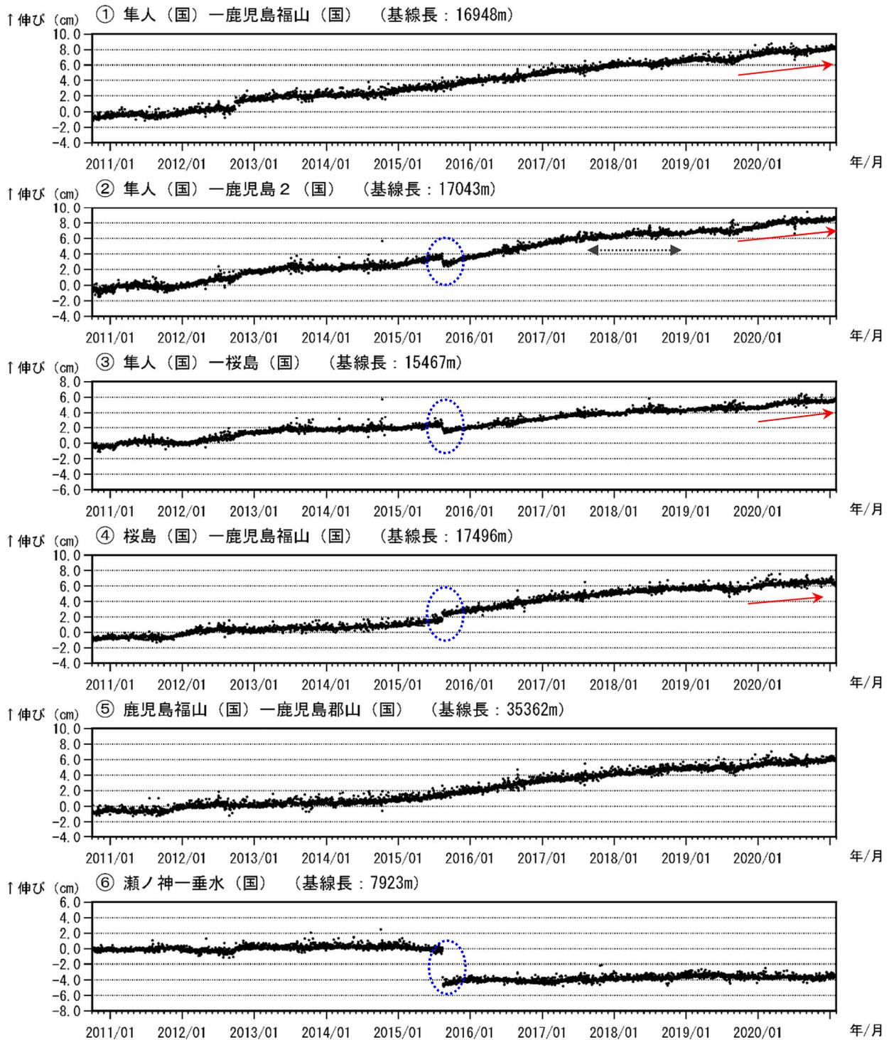
図 9-1 桜島 GNSS 連続観測による基線長変化（2010 年 10 月～2021 年 1 月）
