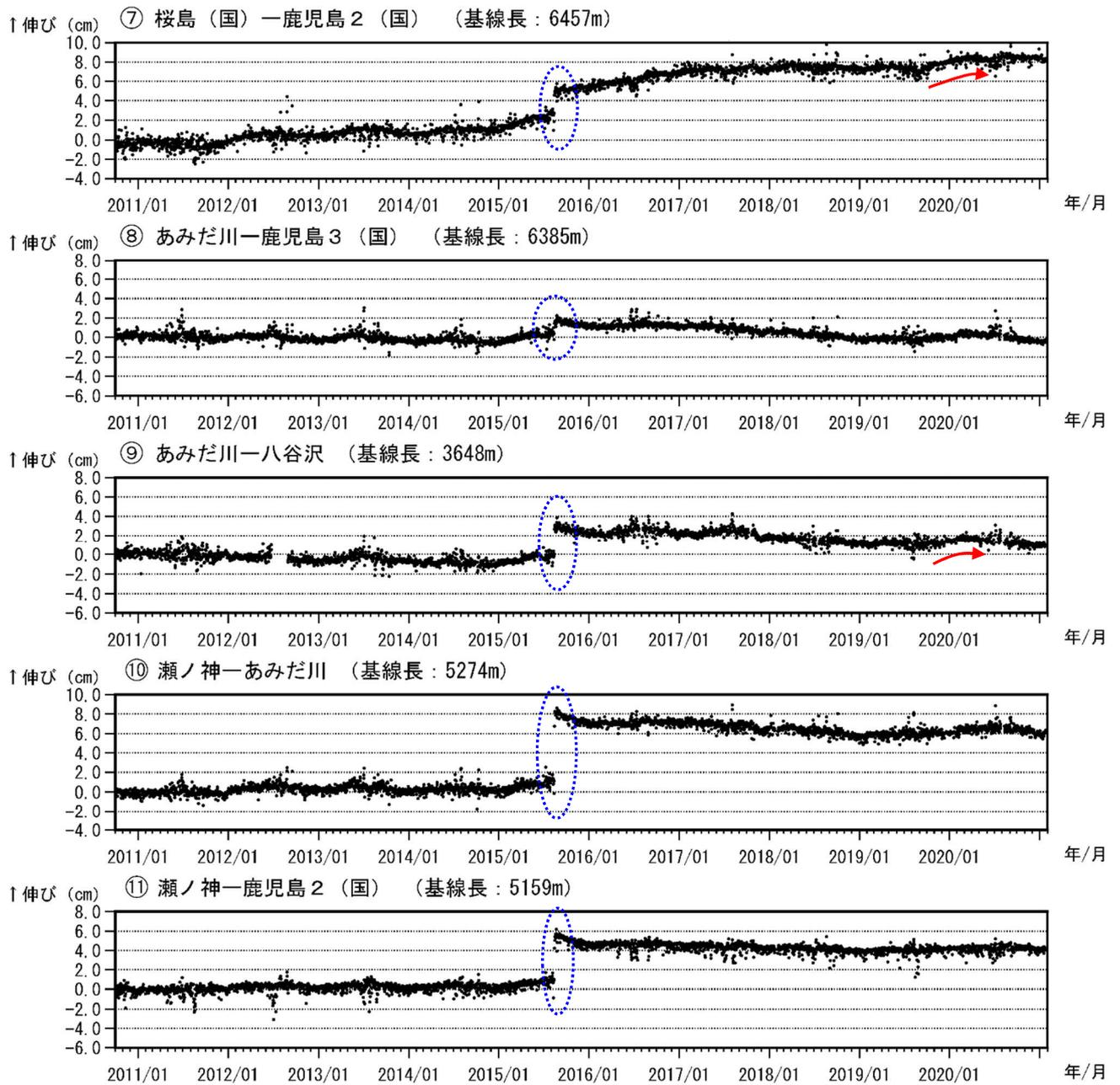
図9-2 桜島 GNSS 連続観測による基線長変化 (2010年10月～2021年1月)
