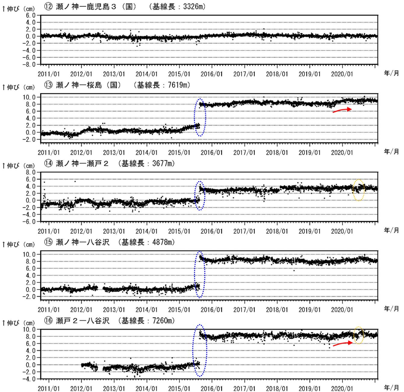
図 9-3 桜島 GNSS 連続観測による基線長変化（2010 年 10 月～2021 年 1 月）
