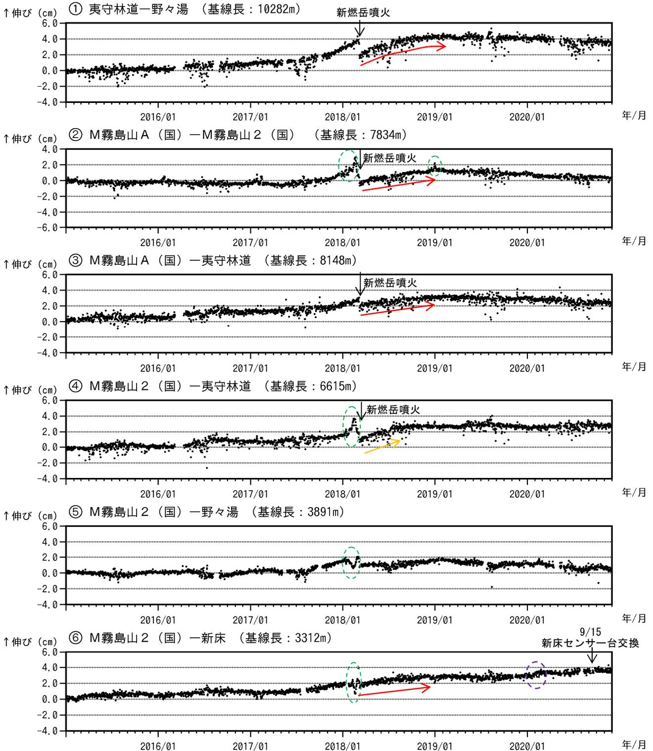
図8 霧島山(えびの高原(硫黄山)周辺) GNSS連続観測による基線長変化 (2015年1月~2020年11月)
