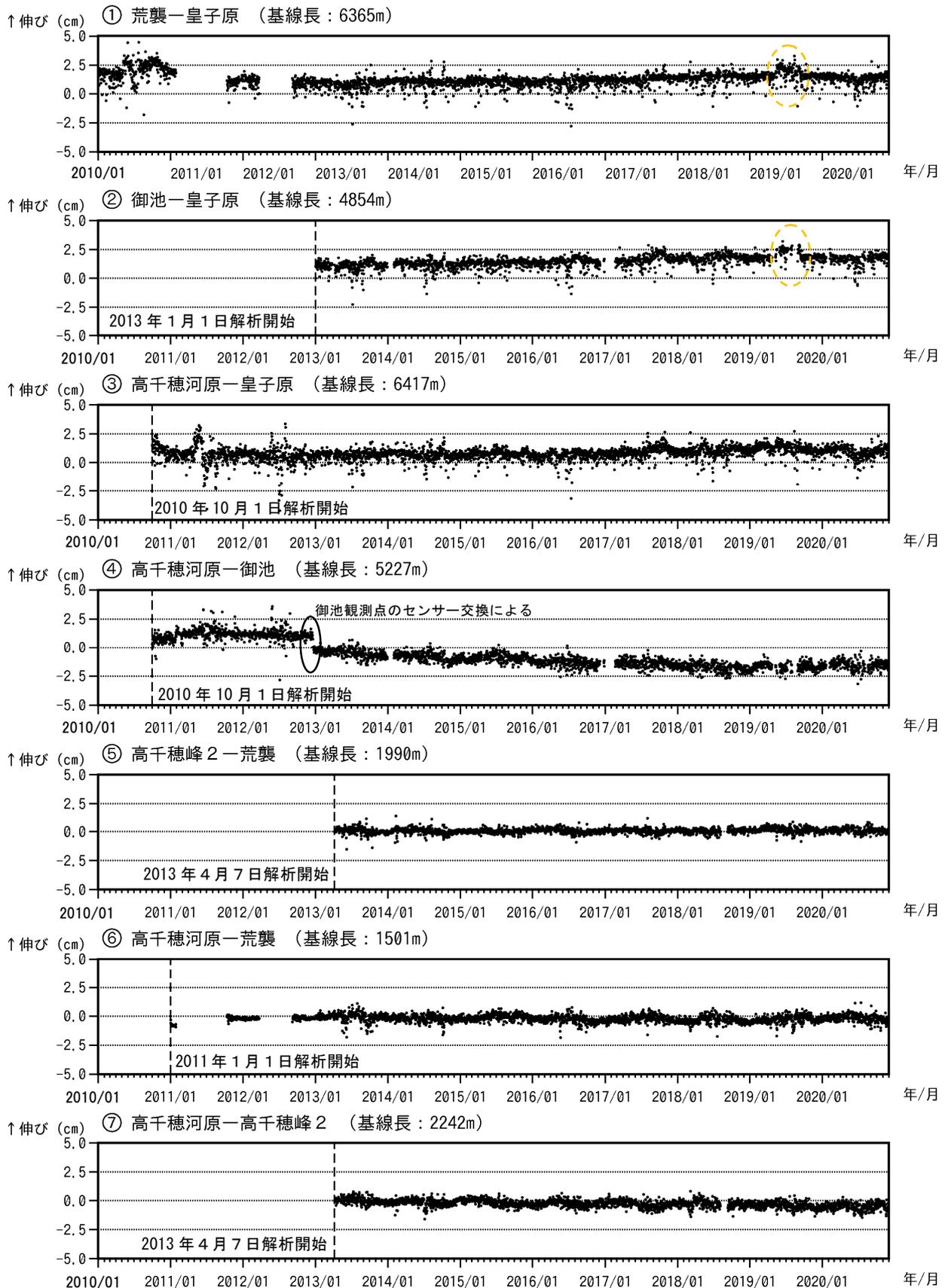
図4 霧島山（御鉢） GNSS 連続観測による基線長変化（2010年1月～2020年11月）
