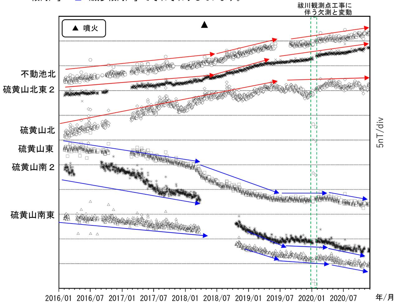
図 12 霧島山（えびの高原（硫黄山）周辺） 全磁力観測点で観測された全磁力変動（2016年2月～2020年11月）
