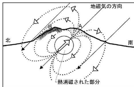
図13 熱消磁に伴う全磁力変化のモデル
