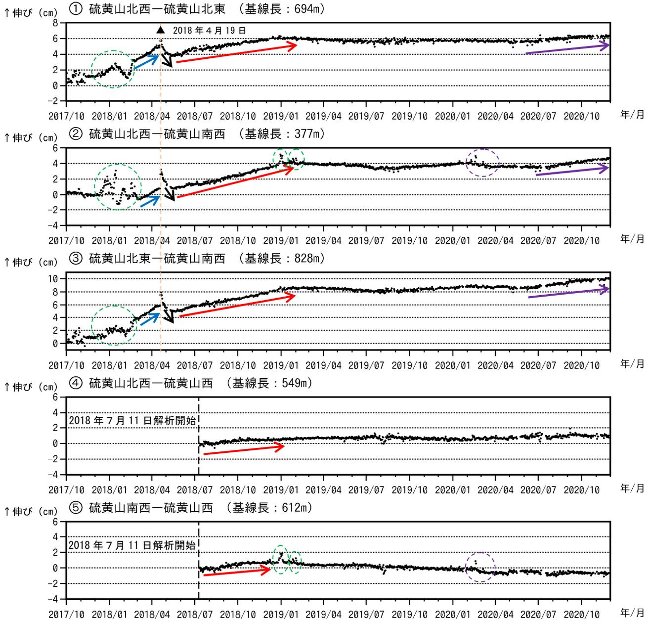
図7 霧島山（えびの高原（硫黄山）周辺） GNSS 連続観測による基線長変化
