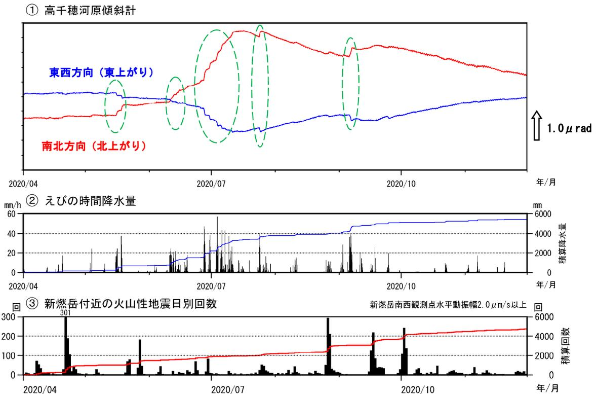
図7 霧島山（新燃岳） 高千穂河原観測点の傾斜変動の状況（2020年4月～2020年11月）
