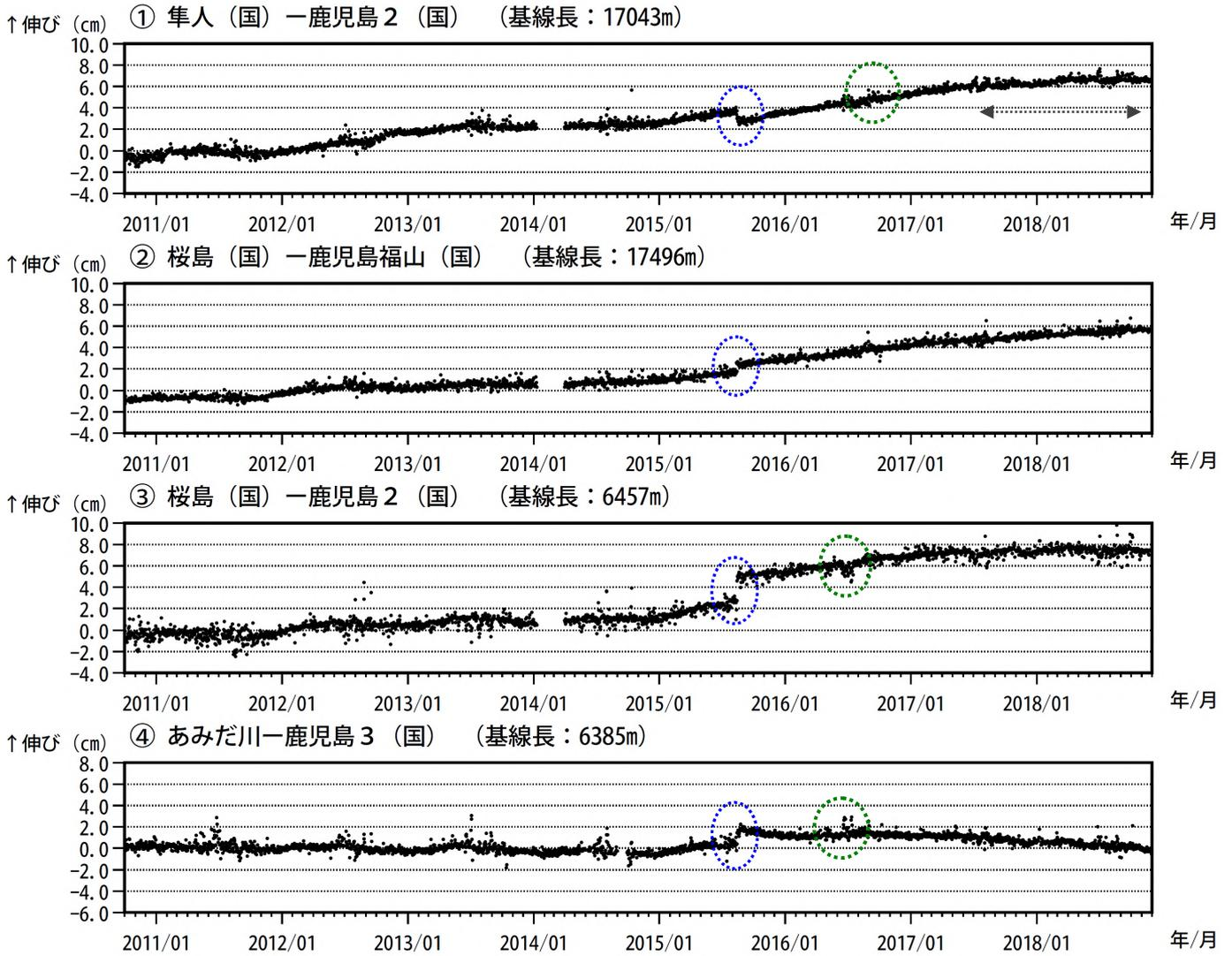
図 6-1 桜島 GNSS 連続観測による基線長変化(2010年10月~2018年11月)
