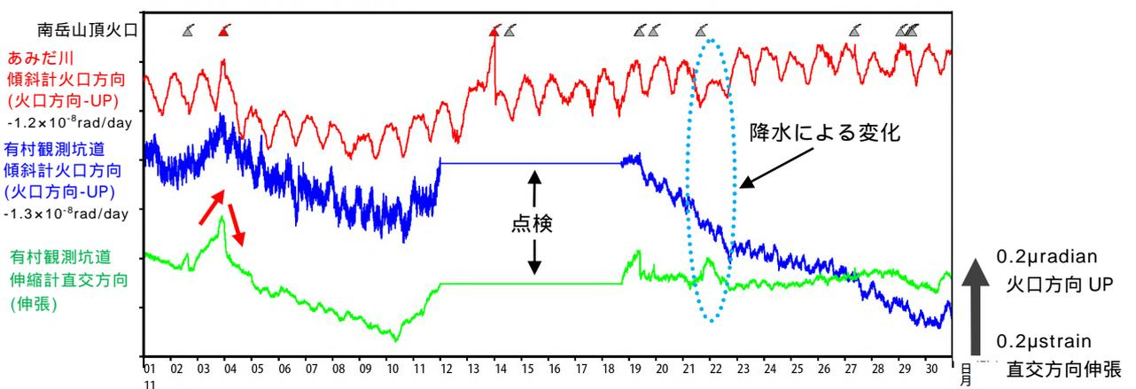
図5 桜島 傾斜計及び伸縮計による地殻変動の状況(2018年11月1日~11月30日)
