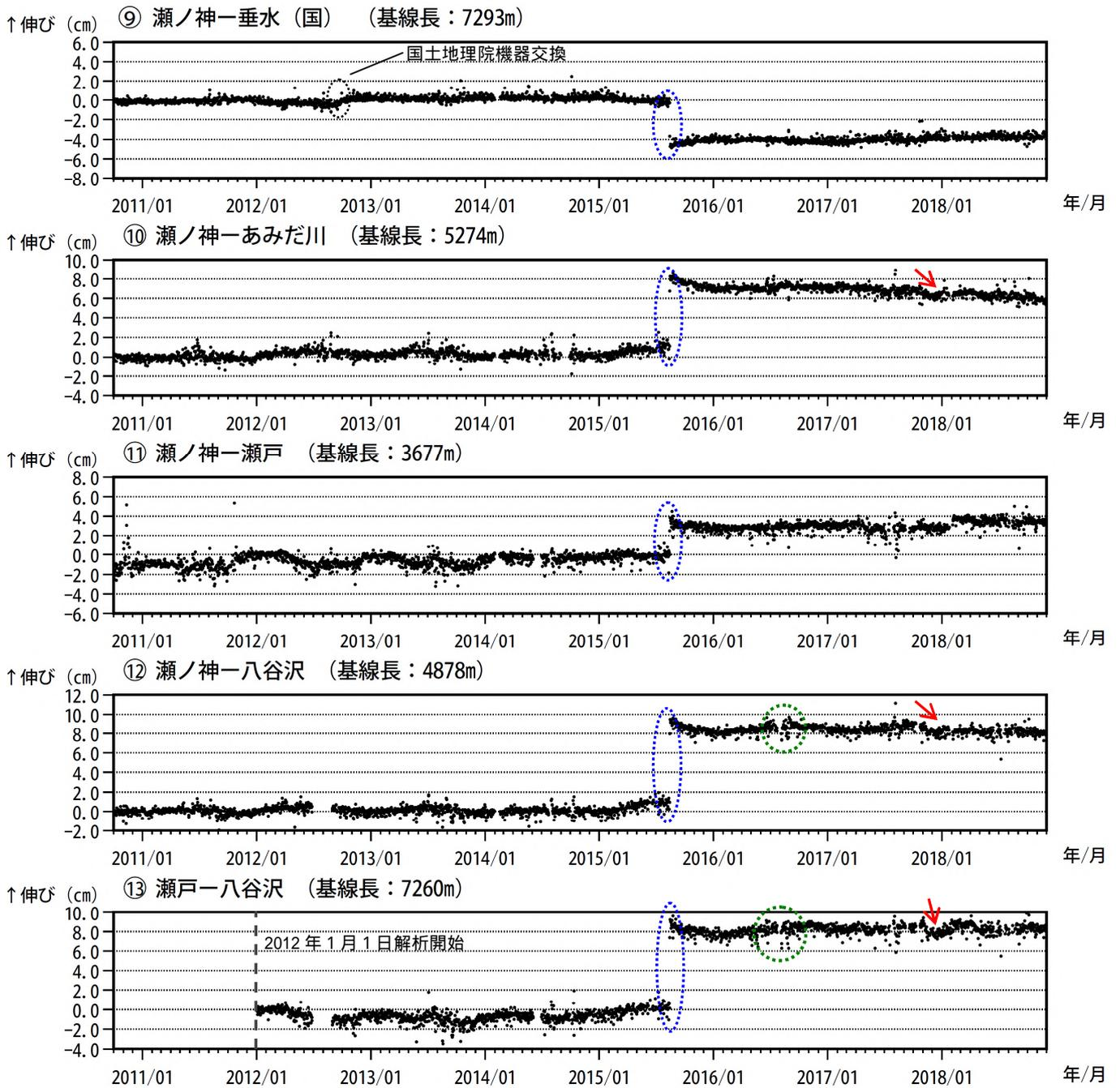
図 6-3 桜島 GNSS 連続観測による基線長変化 (2010 年 10 月 ~ 2018 年 11 月)
