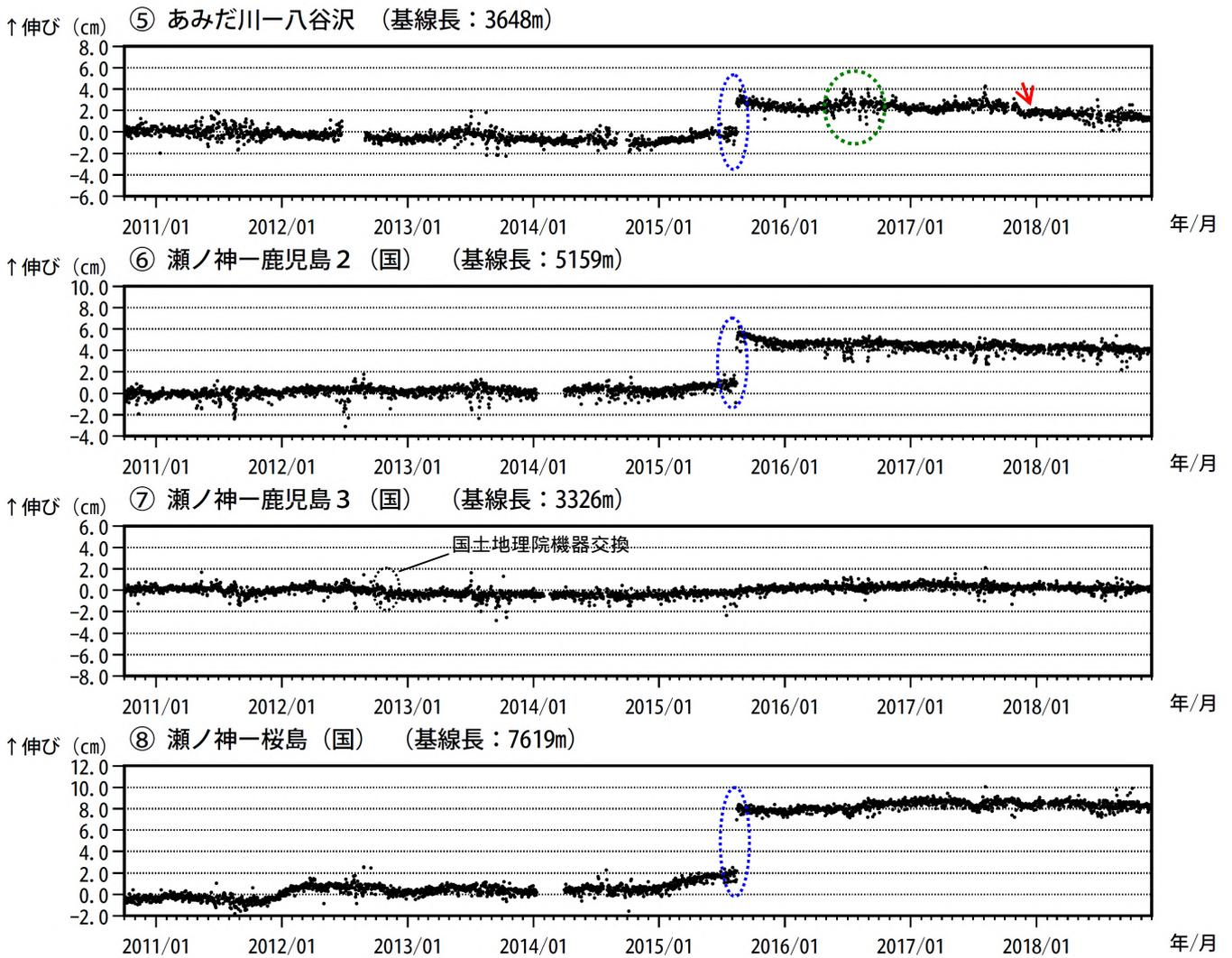
図 6-2 桜島 GNSS 連続観測による基線長変化 (2010 年 10 月 ~ 2018 年 11 月)
